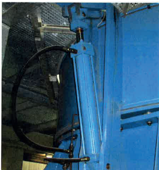
Bild 1: Leistungselement Zylinder an einer Prüfmaschine
