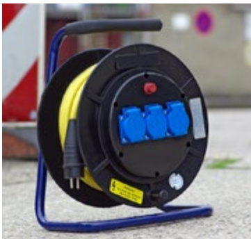
Abb. 2: Geeigneter Leitungsroller und Typschild mit notwendigen Angaben
