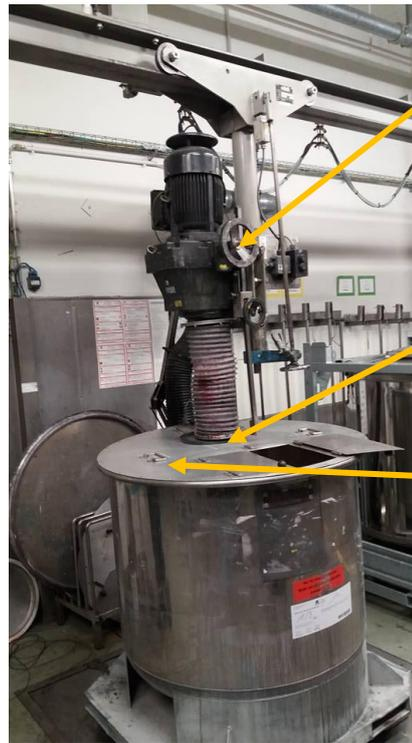
Sicherungseinrichtung gegen horizontale Bewegung: mit Rührwerksantrieb verriegelt
