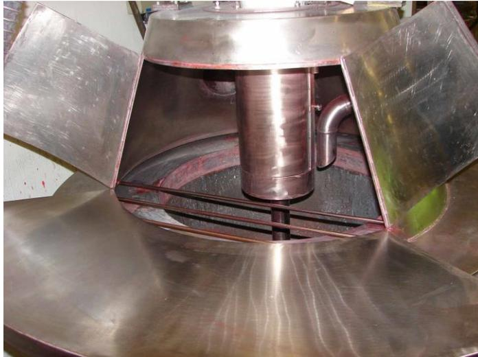
Bild 4: Durch Schutzrohr schwer erreichbare Welle
