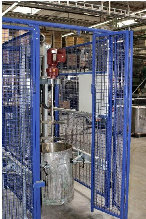
Bild 5: Durch (verriegelte) trennende Schutzeinrichtungen gesichertes Rührwerk
