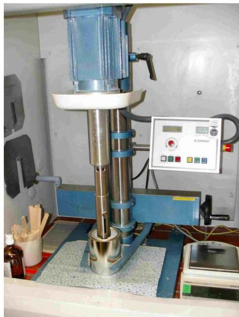
Bild 7: Labor-Dissolver mit ausreichenden Schutzeinrichtungen: überwachte Spann-
