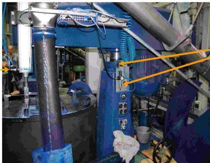
Bedienelemente der pneumatischen Zweihand-Steuerung
