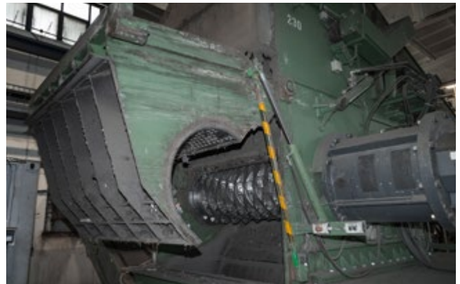
Abb. 64 Mechanische Sicherung des geöffneten Mühlendeckels (gelb-schwarze Stange)
