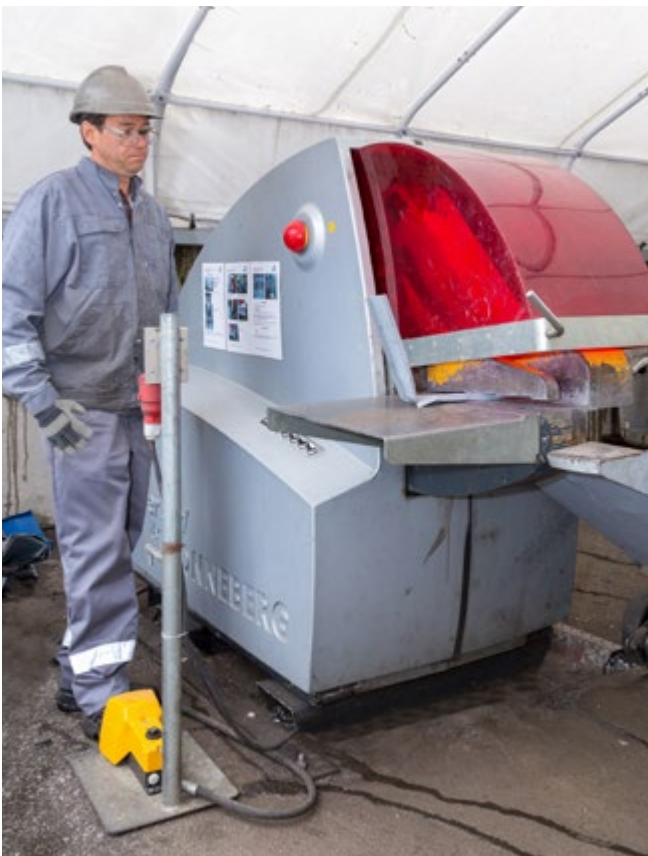
Abb. 80 Fixierung des Schneidgutes durch den Niederhalter
