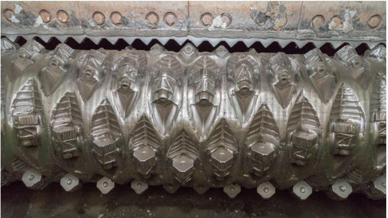
Abb. 63 Rotor- und Statormesser mit auswechselbaren Schneidwerkzeugen
