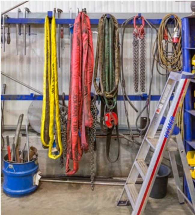
Abb. 111 Geschützte und übersichtliche Aufbewahrung von Anschlagmitteln
