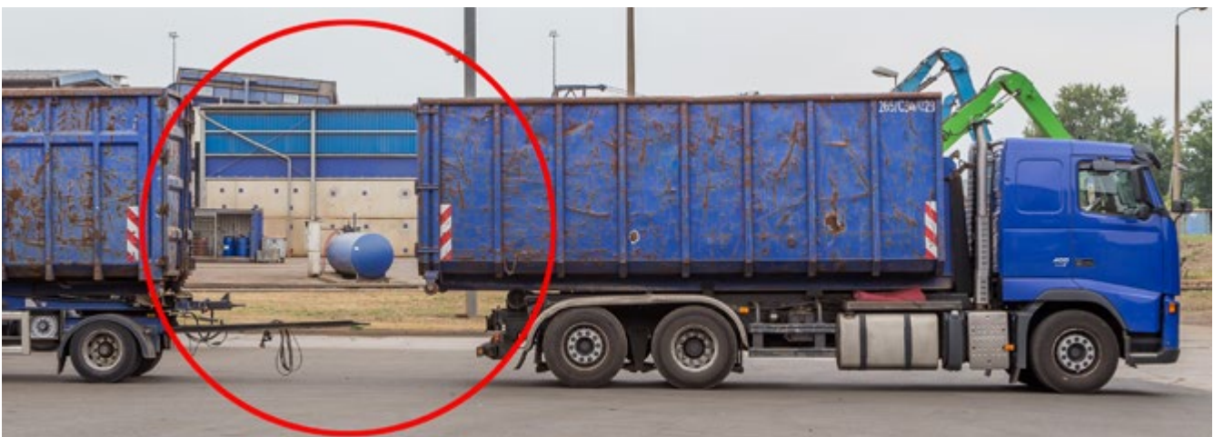
Abb. 2 Zwischen Fahrzeug und Anhänger darf sich niemand aufhalten. Das Kupplungsmaul am Fahrzeug und die Deichsel des Anhängers müssen genau fluchten.
