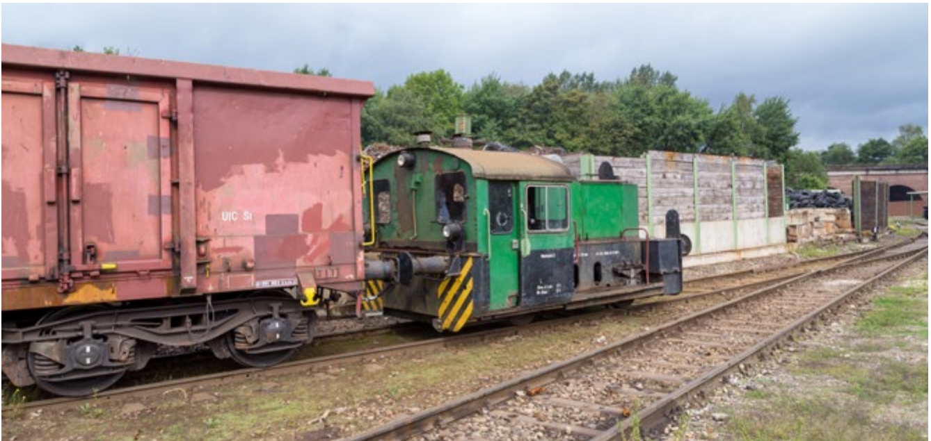
Abb. 12 Verziehen von Waggons mit Rangierlokomotive
