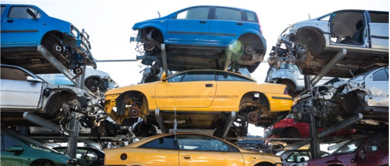
Abb. 90 Spezielles Kragarmregal für Fahrzeugkarossen
