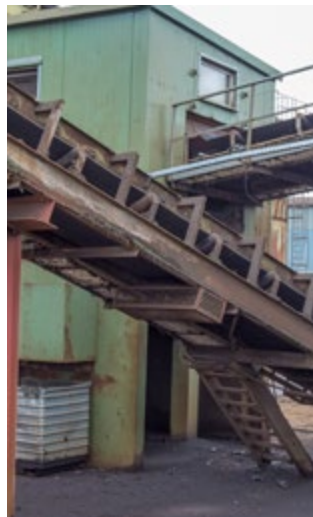
Abb. 42 Mit abnehmbaren Verkleidungen gesicherte Untergurtrollen
