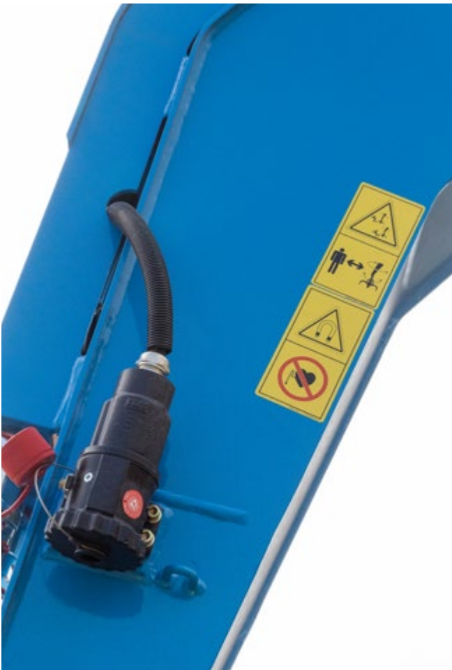
Abb. 34 Warnzeichen am Ausleger des Baggers
