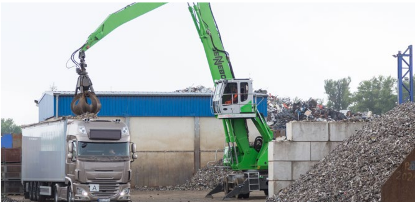
Abb. 32 Mobilbagger mit hebbarem Führerhaus für bessere Übersicht.
