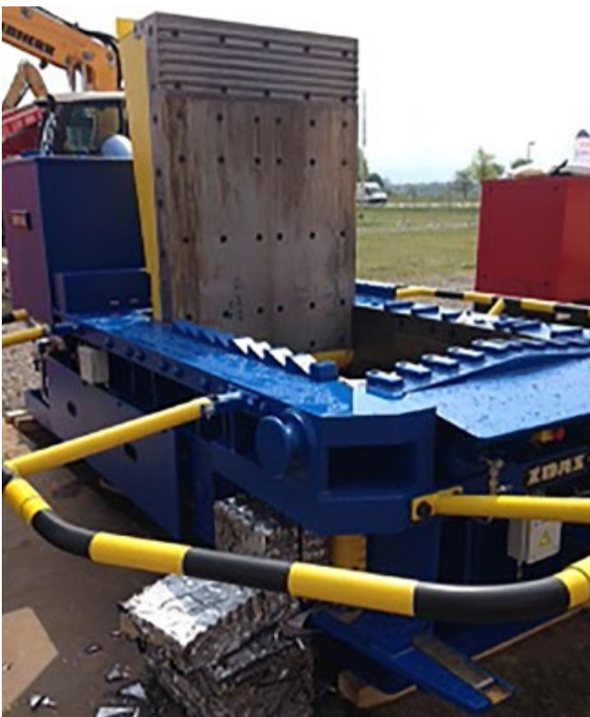
Abb. 59 Mobile Deckelpresse mit Abweisbügel
