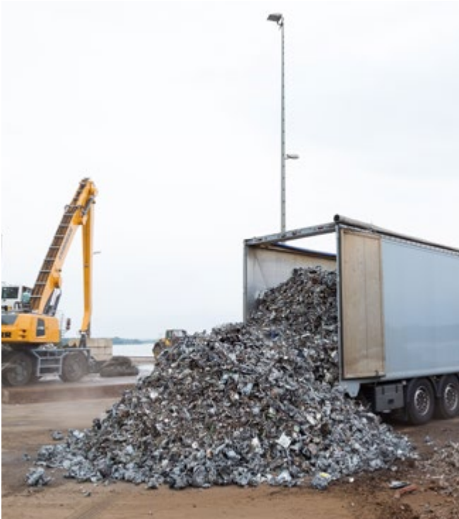
Abb. 99 Bei Fahrzeugen mit Schubboden ist bereits bauartbedingt die Fallhöhe reduziert
