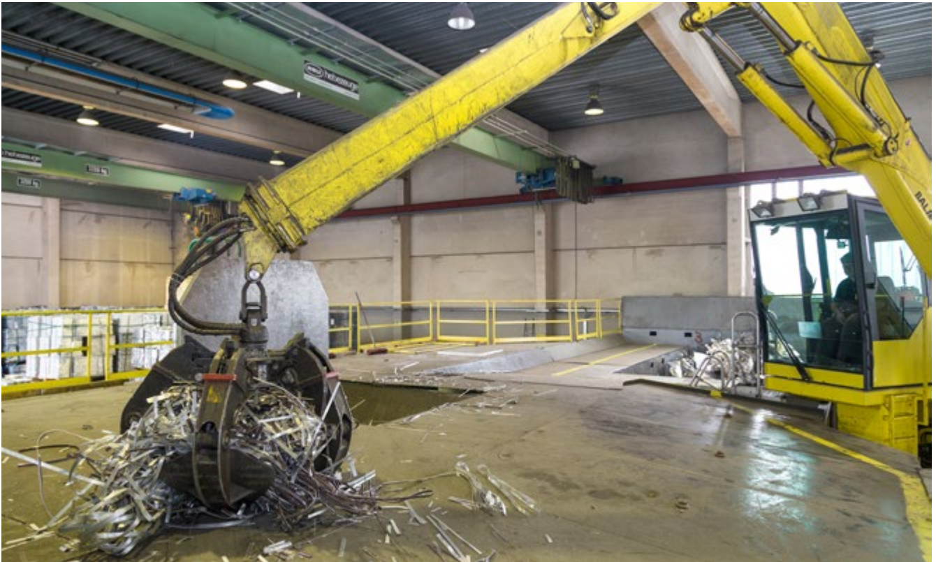
Abb. 57 Befüllung einer stationären Paketpresse (Deckelpresse) mit Bagger
