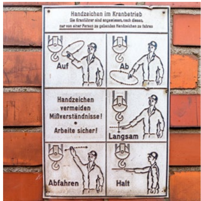
Abb. 40 Handzeichen zur Verständigung zwischen Anschläger und Kranführer
