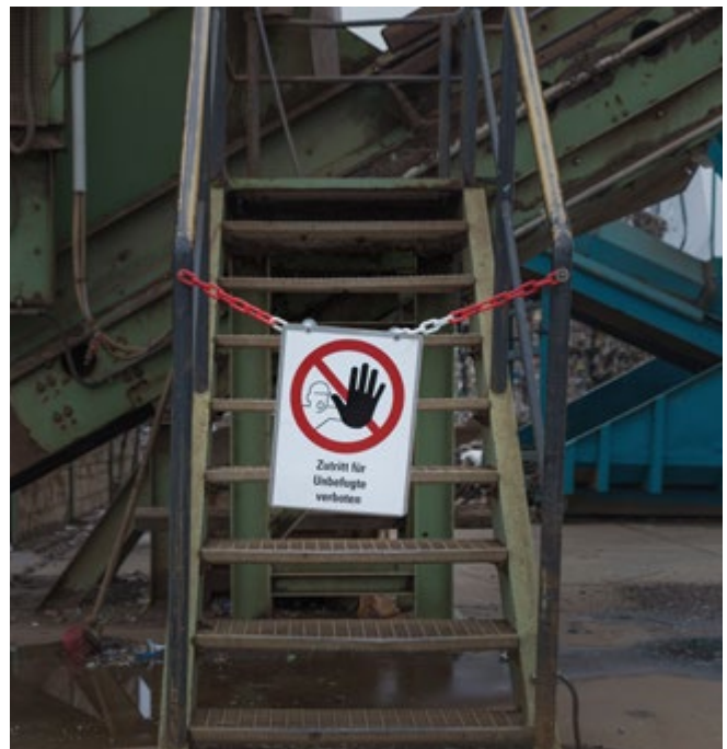
Abb. 61 Wirksame Abspernung für Fußgänger an Zugangstreppe
