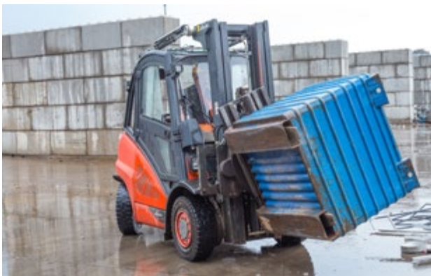
Abb. 36 Gabelstapler mit Drehgerät zum einfachen Auskippen von Metallbehältern
