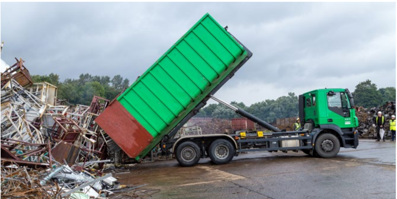
Abb. 1 Abkippen von Schrott aus Abrollbehälter
