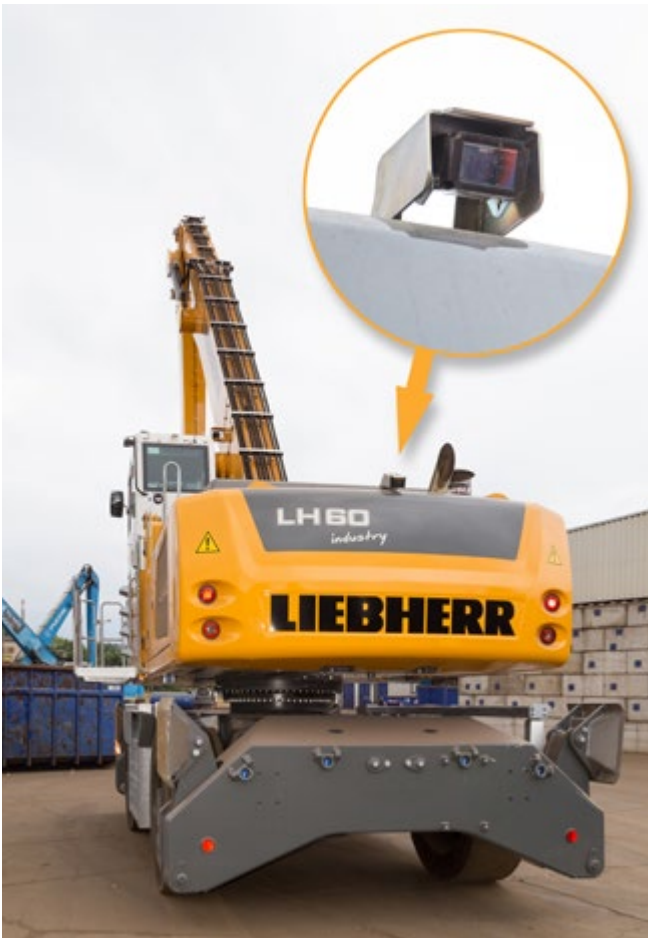
Abb. 30 Bagger, der mit Kamera-Monitor-System ausgestattet ist.
