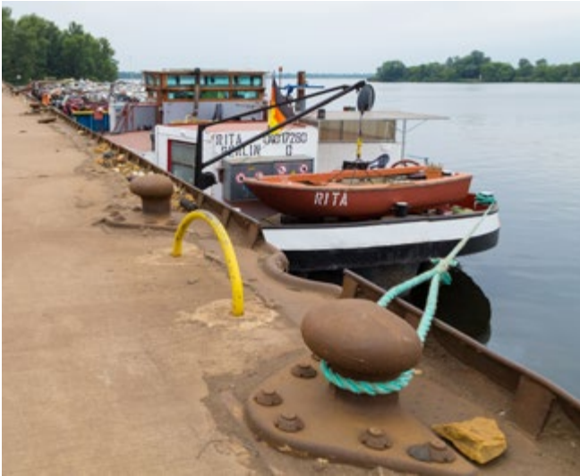
Abb. 17 Leinen können beim Los- und Festmachen zurückschlagen und z. B. zu Prellungen führen
