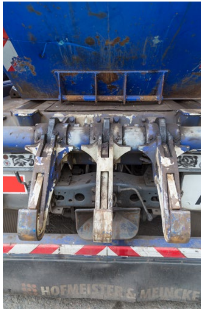
Abb. 3 Dieser Behälter benötigt ein Fahrzeug mit 3 Fanghaken.
