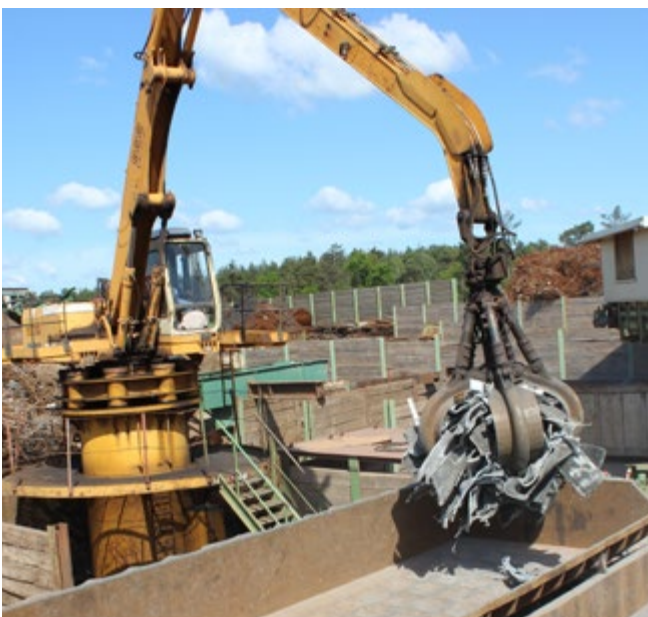
Abb. 75 Hohe Fahrerkabine des stationären Baggers ermöglicht freie Sicht in das Scherenbett
