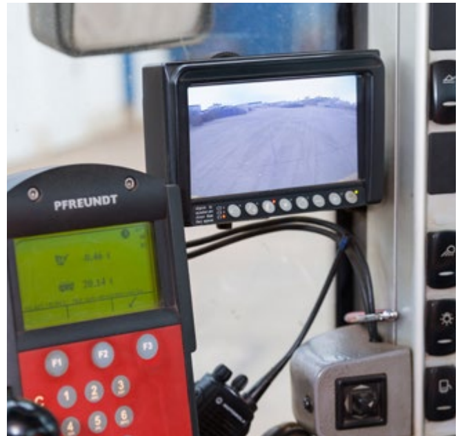
Abb. 31 Monitor in der Bedienerkabine des Baggers.
