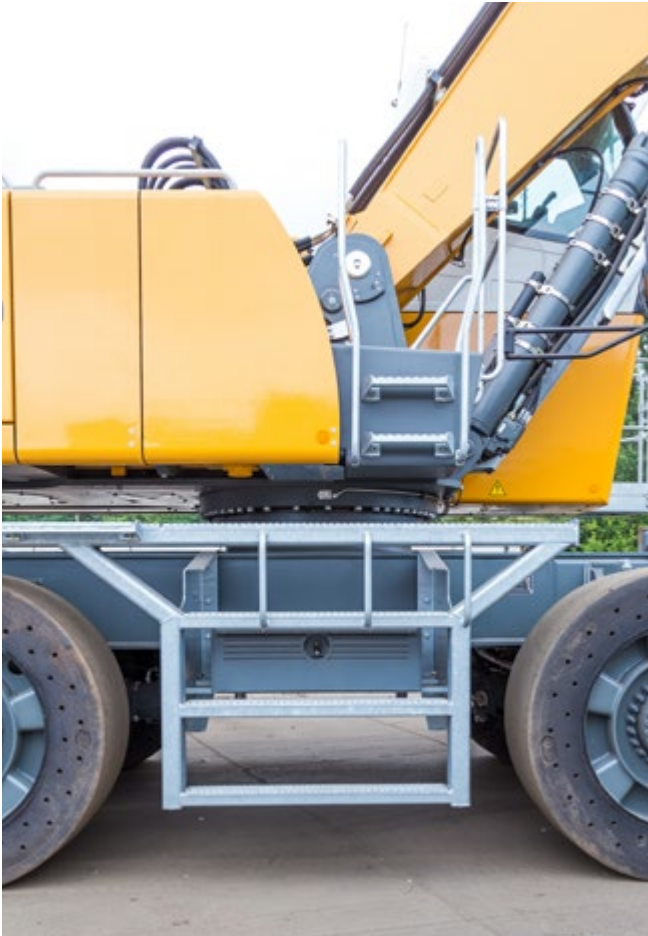
Abb. 33 Viele Hersteller dimensionieren Aufstiege und Haltegriffe großzügig.
