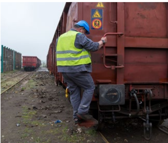
Abb. 14 Sicherer Aufstieg mit Haltegriffen
