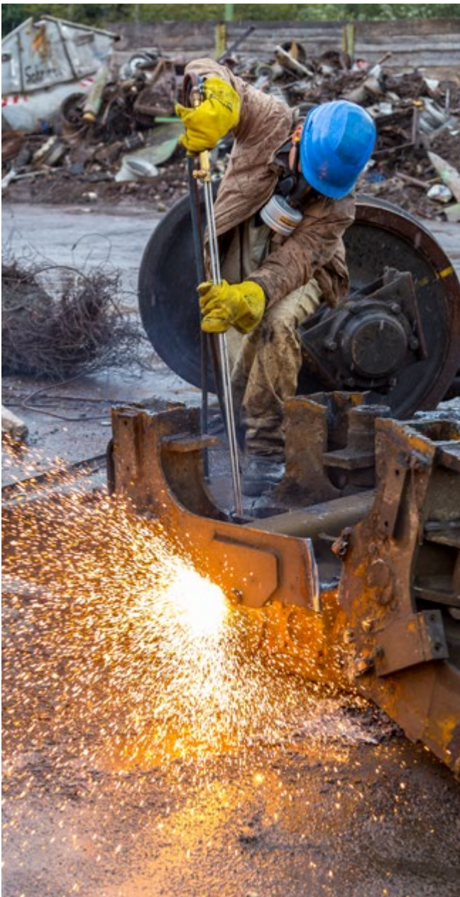
Abb. 53 Stationärer Arbeitsplatz für Brennschneidearbeiten auf einem Schrottplatz
