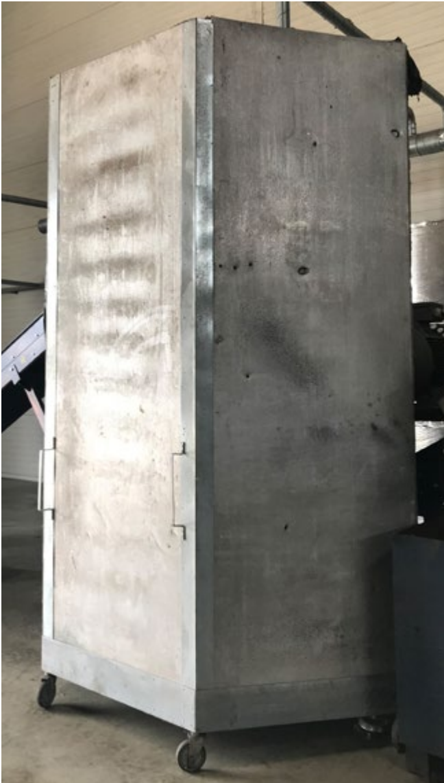
Abb. 105 Mobiler Schirm zur Lärminderung in der Umgebung der Anlage
