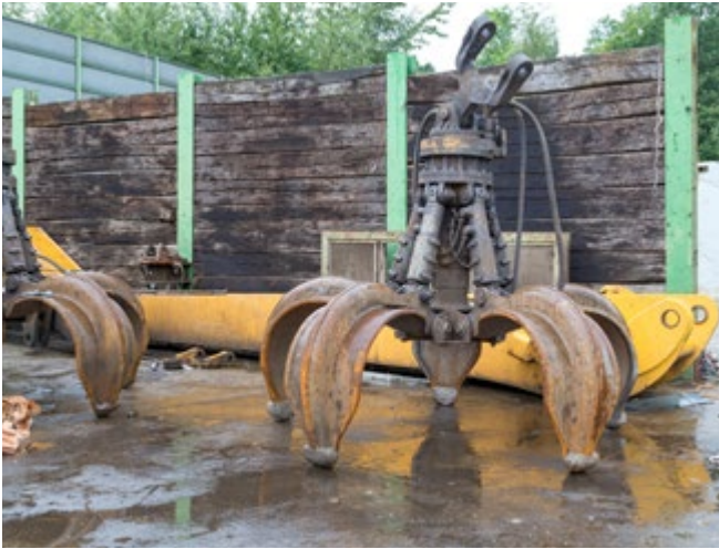
Abb. 26 Mehrschalengreifer kippstabil für die Montage aufgestellt
