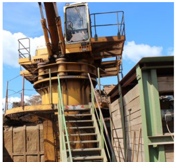
Abb. 76 Hohe Fahrerkabine des stationären Baggers ermöglicht freie Sicht in das Scherenbett
