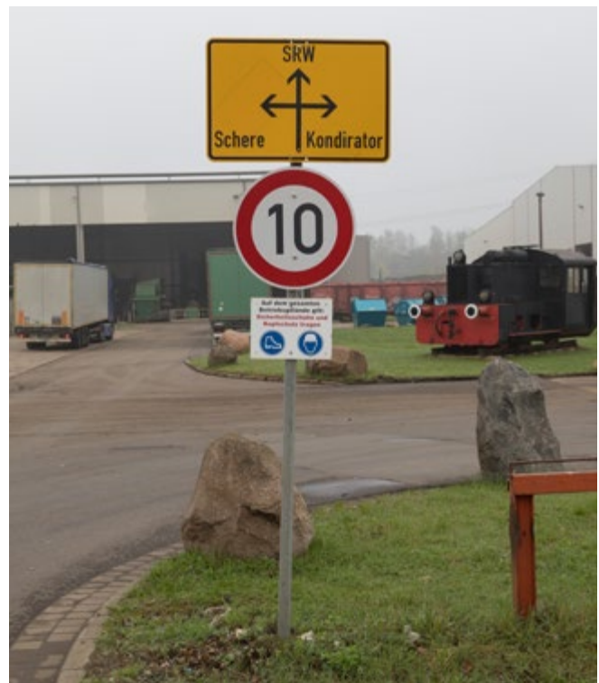
Abb. 23 Beschilderung innerbetrieblicher Verkehrswege zur Orientierung und gleichzeitigem Hinweis auf Höchstgeschwindigkeit und PSA-Tragegebot.
