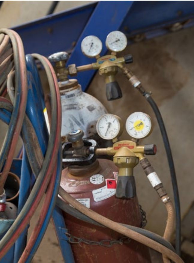
Abb. 55 Sauerstoff- und Brenngasflasche mit Gebrauchsstellen- vorlagen gegen Gasrücktritt und Flammendurchschlag am Flaschendruckminderer
