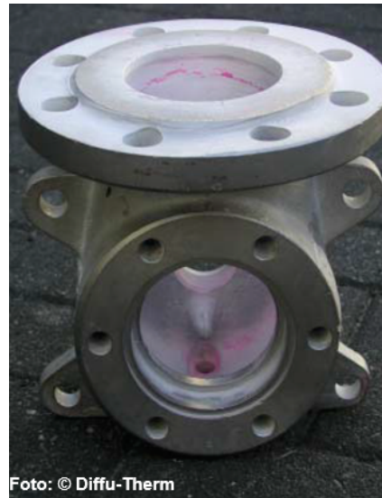
Abbildung 13.3: Gussteil nach Anwendung des Rot-Weiß-Verfahrens; Quelle: Helmut Klumpf Technische Chemie KG, Herten
