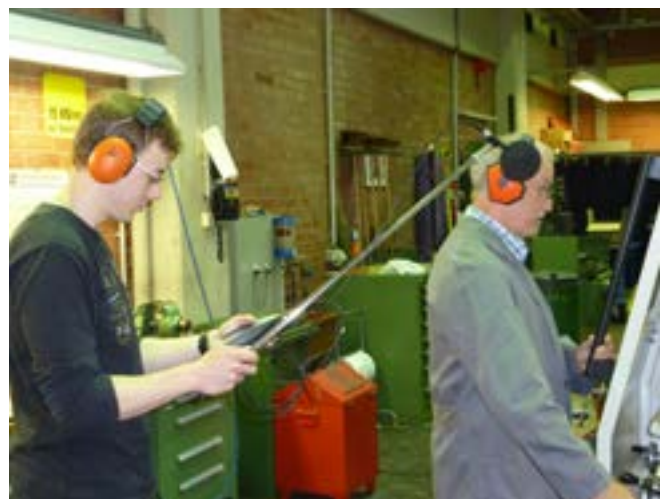
Abb. 5 Nachführen des Mikrofons mit Hilfe einer Stativstange [5]
