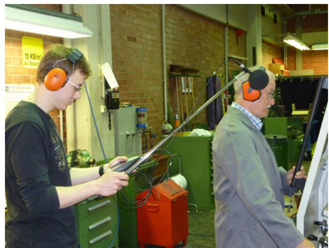
Abb. 5 Nachführen des Mikrofons mit Hilfe einer Stativstange [5]
