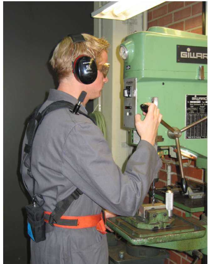
Abb. 6 Einsatz eines Schalldosimeters in Verbindung mit einem speziellen Gurtsystem zur Fixierung des Mikrofons [5]
