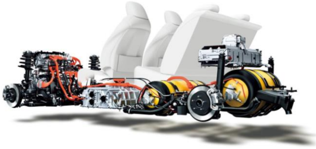
Bild 3: Wasserstoffspeicher in einem Brennstoffzellen-Fahrzeug
