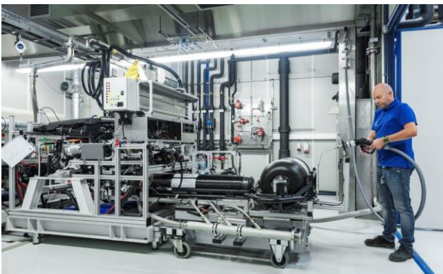
Bild 6: Brennstoffzellen-Testlabor mit Hochdruckbetankungseinrichtung
