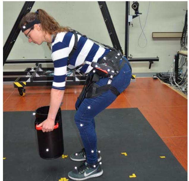
Versuchsaufbau zum Testen von Exoskeletten im Labor Bild: IFA
