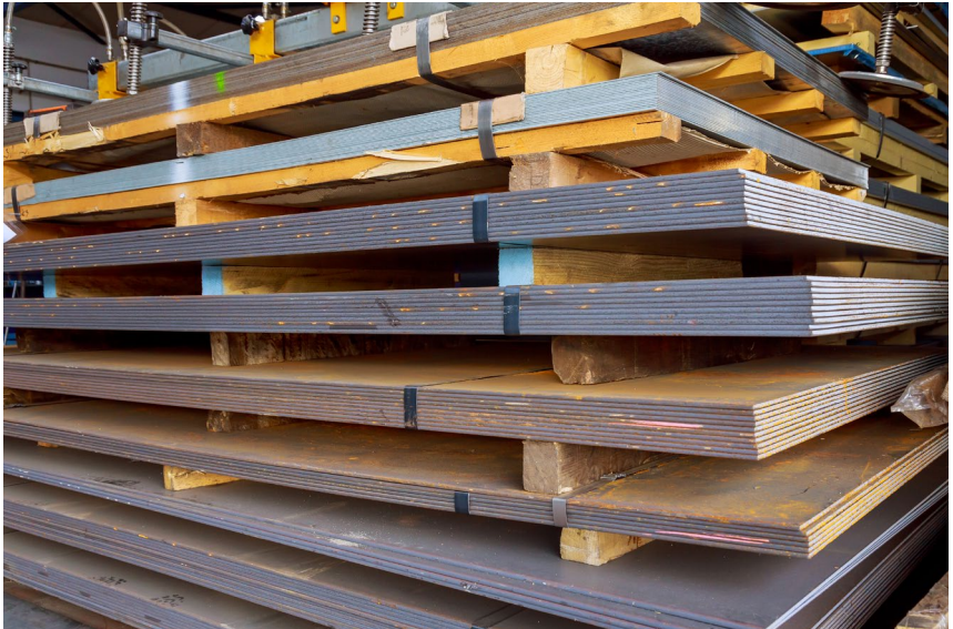
Abb. 13 Beispiel Lagerung von unterschiedlichen Blechpaketen
