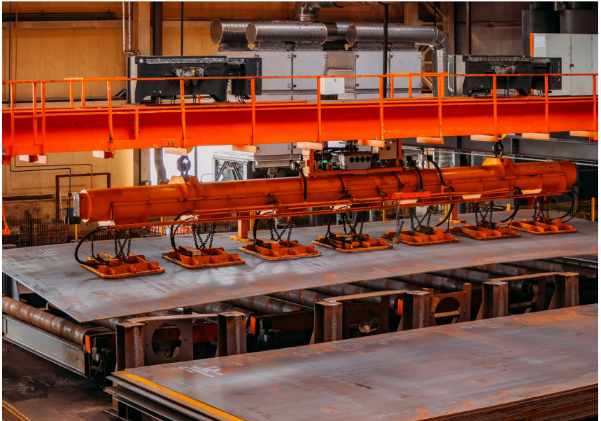
Abb. 9 Deckenkran mit Vakuum-Handhabungsgreifern zum Anheben von Eisenblechen
