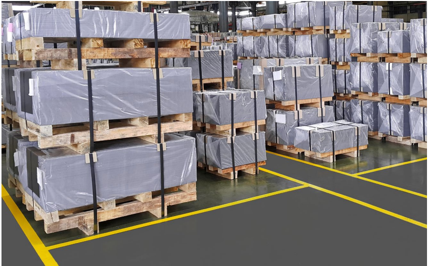
Abb. 19 Beispiel für die Lagerung von Blechpaketen mit Stahl-Umreifungsband
