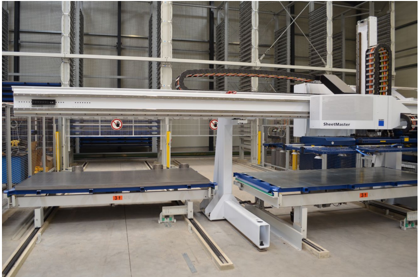
Abb. 18 Beispiel einer Stanz-Laser-Maschine mit automatisierter und somit personloser Anbindung an das Lagersystem. Vakuumsauger entnehmen die Bleche und führen sie selbstständig der Maschine zu.
