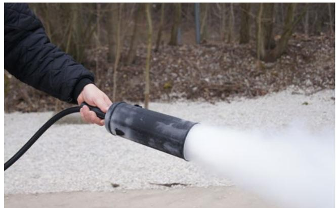
Abb. 2 CO<sub>2</sub>-Feuerlöscher mit Schneerohr / Ausströmen von „CO<sub>2</sub>-Nebel“
