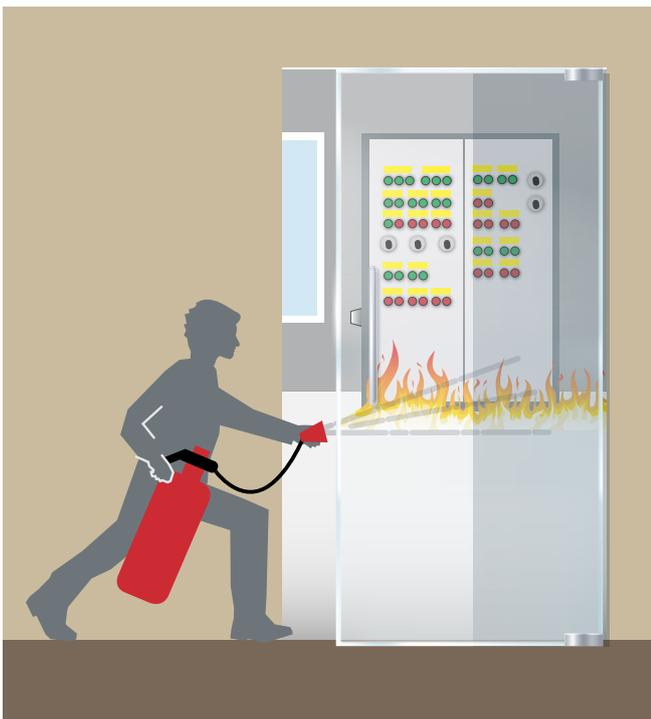
Abb. 9 Löschen durch den Türspalt
