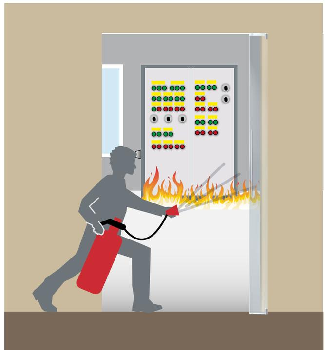
Abb. 10 Löschen durch die geöffnete Tür
