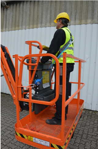
Abbildung 3 - In der Länge verstellbares Verbindungsmittel mit energieabsorbierender Funktion
