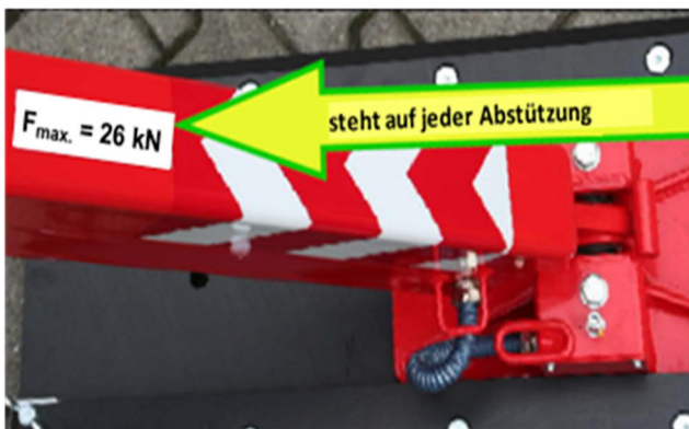
Bild 5: Abstützung mit angegebenem max. Stützdruck
