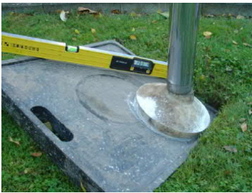
Bild 7: Außermittige Auflage erzeugt Kippmoment der Unterlegplatte! Keine gleichmäßige Lastverteilung! Gefahr des Einsinkens in den Untergrund!
