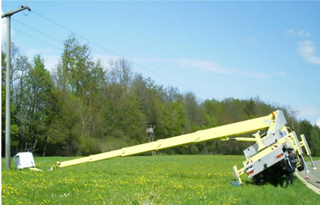
Bild 1: Umgestürzte FHAB durch zu geringe Bodentragfähigkeit
