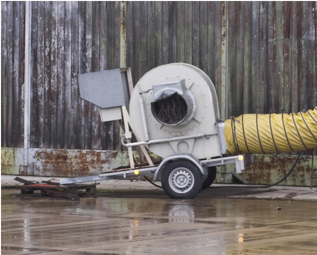
Bild 2: Ventilator, ca. 10.000m 3 /h
