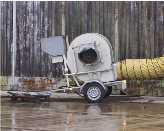
Abbildung 2 – Ventilator, ca. 10.000 m<sup>3</sup>/h
