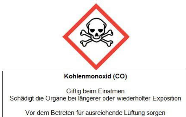
Bild 1: Kennzeichnung von Bereichen mit erhöhter CO-Konzentration
