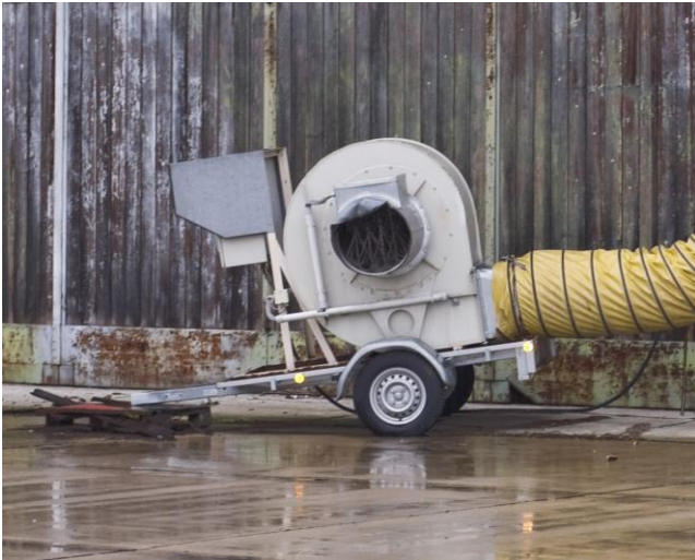
Bild 2: Ventilator, ca. 10.000m 3 /h
