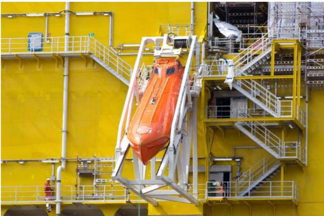
**Bild 2:** Freifallrettungsboot mit Aus- und Einsetzvorrichtung
