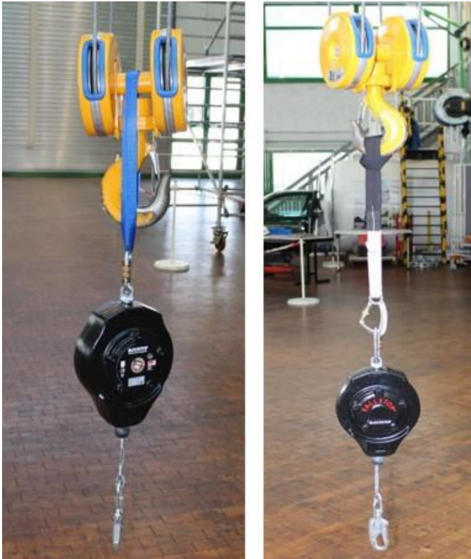
Abbildung 3 – Befestigung an der Unterflasche (links), Befestigung am Lasthaken (rechts)
