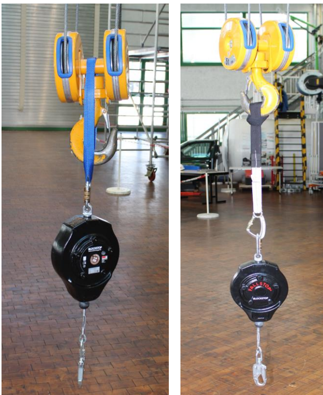
Bild 3: Befestigung an der Unterflasche (links), Befestigung am Lasthaken (rechts)
