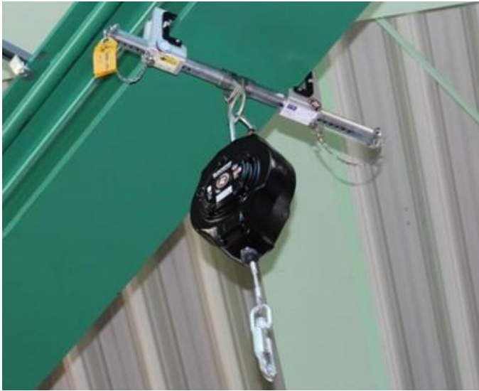
Abbildung 2 – Temporäre Anschlagvorrichtung mit einem Einzelanschlagpunkt an der Krankonstruktion
