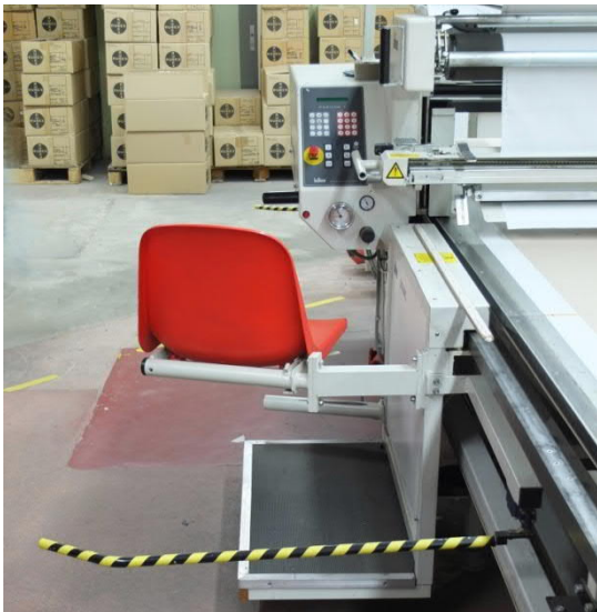
Bild 2: Ein Schaltbügel sichert die Fahrbewegung am Legewagen
