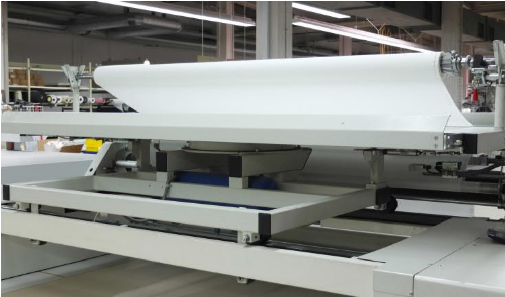
Bild 4: Stoffballenspeicher, verfahrbar mit Wendeeinrichtung
