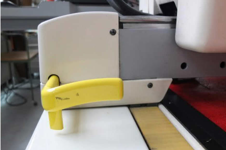
Bild 6: Schaltleisten sichern die Fahrbewegung der Schneidbrücke
