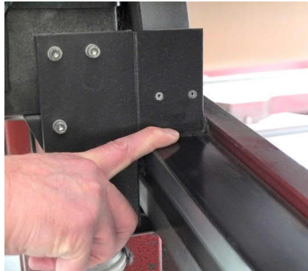
Bild 3: Absicherung der Räder durch Schienenräumer
