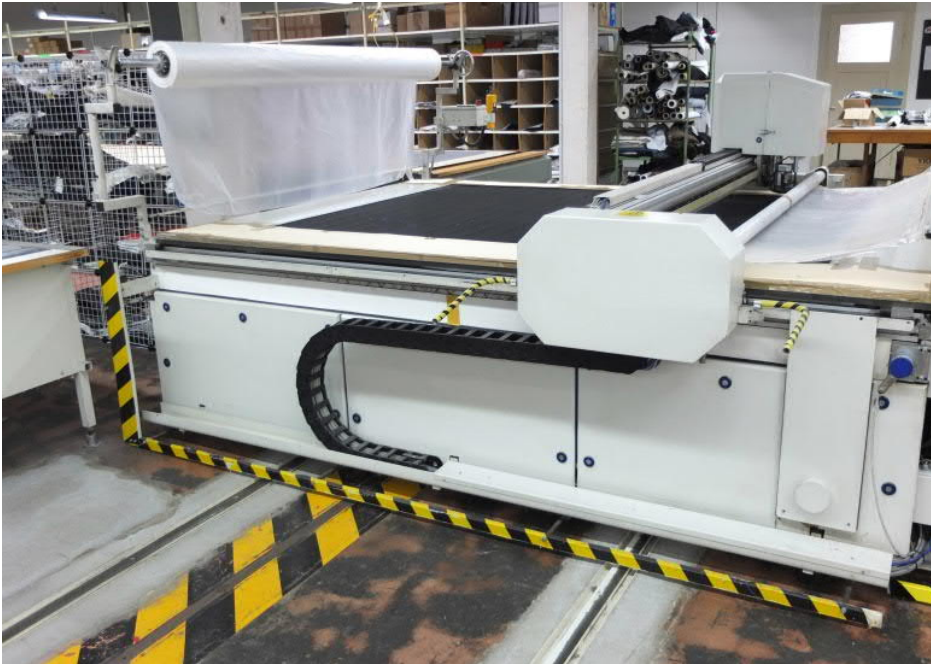
Bild 8: Schaltleisten sichern Fahrbewegungen des Transfertischs
