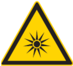
Bild 1: Das Zeichen „Warnung vor optischer Strahlung“ muss bei den Risikogruppen 2 und 3 angebracht sein [7]
