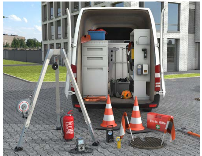
Abb. 27 Gut ausgerüstet für den Einstieg in Schächte.
