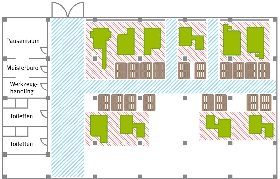
Abb. 2.4 Feinplanung mit detaillierter Maschinenpositionierung, optimierten Verkehrswegen etc.
