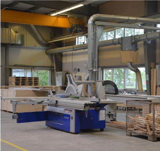
Abb. 13.1.2 Formatkreissäge einer Schreinerei
