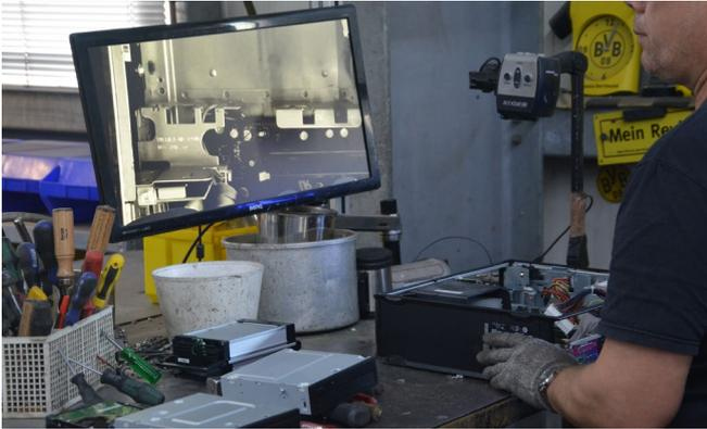
Abb. 13.8.4 Zerlegearbeitsplatz für Elektro-/Elektronikschrott mit einem optischen Unterstützungssystem
