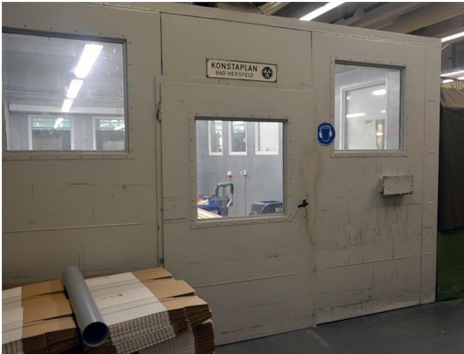
Abb. 9.4 Schallschutzkabine
