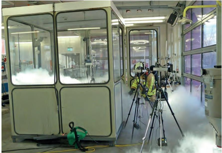
Untersuchung zum Einsatz eines CO<sub>2</sub>-Löschers in einem engen Raum
