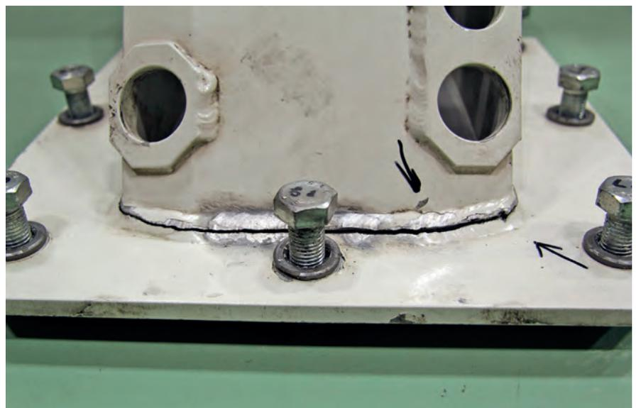
Gebrochene Schweißnaht an einem Teleskoparm
