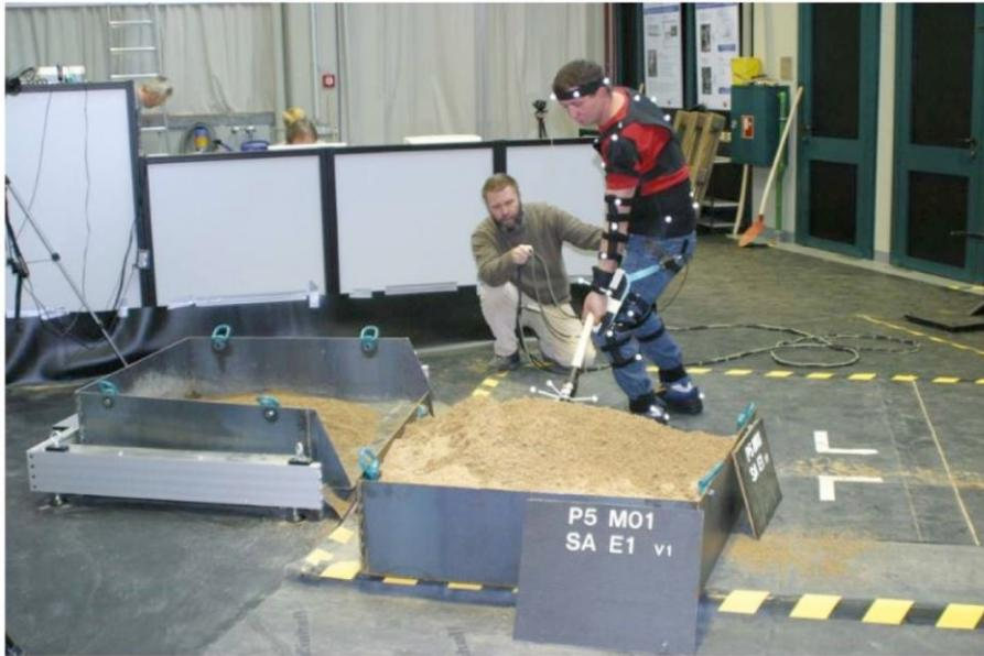
Abbildung 3.3.3-6: Messfeld zur Untersuchung von Schaufelvorgängen in unterschiedlichen Konstellationen mit Schüttgütern, die in einer Stahlwanne deponiert und in eine andere Wanne umgeschaufelt werden konnten (aus Glitsch et al. 2008)
