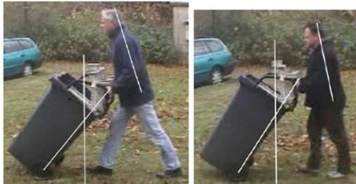
Abb. 8 Vergleich der Körperhaltungen der beiden VP beim Schieben von Behälter 4 (Bügelgriff, Raddurchmesser 25 cm)
