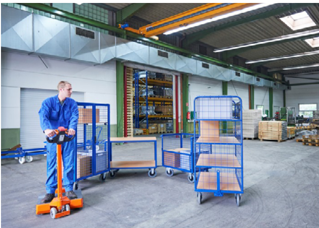
Abb. 10 Routenzug mit Stehsclepper und verschiedenen Anhängerformen
