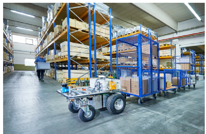
Abb. 4 Routenzug mit FTS und Regalwagen
