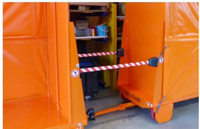
Abb. 25 Durchtrittssicherung bei Routenzügen
