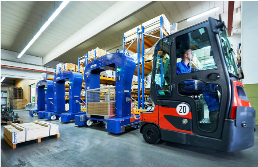
Abb. 1 Routenzug mit Sitzschlepper und Anhänger U-Frame
