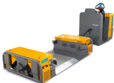
Abb. 16 Allradgelenkter Anhänger mit einer anhebbaren Ladefläche erlaubt auch ergonomisches Durchschieben der Ladung
