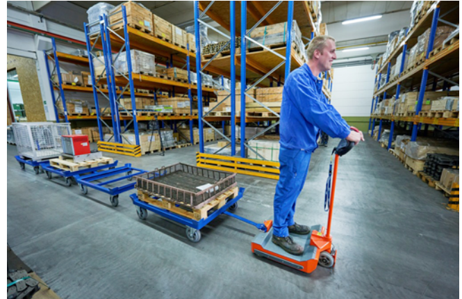
Abb. 2 Routenzug mit Stehschlepper und Palettenfahrrahmen
