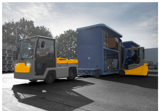
Abb. 12 Auf Außeneinsatz angepasster Schlepper im Einsatz
