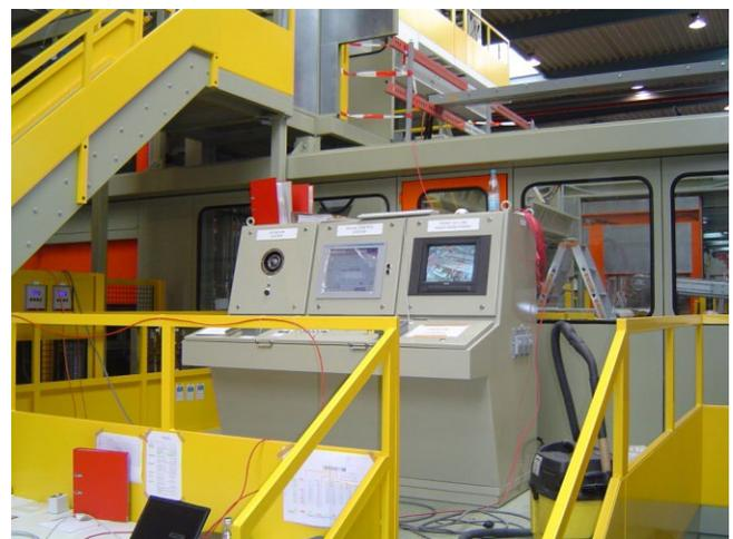
**Bild 4:** Leitstand mit Videoüberwachung
