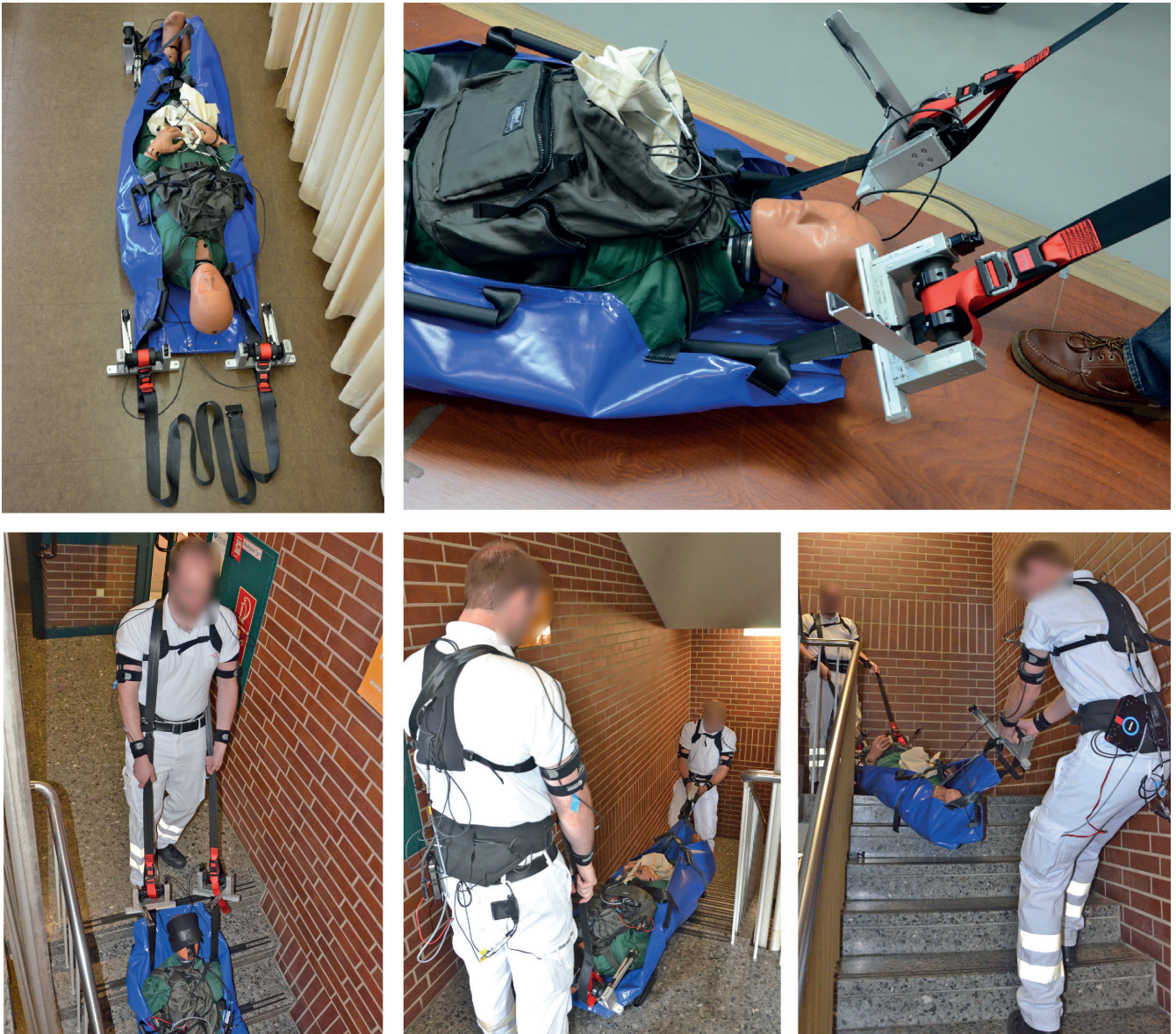
Abbildung 2.6: Treppengleitstuhl mit Dummy und Messtechnik im Einsatz
