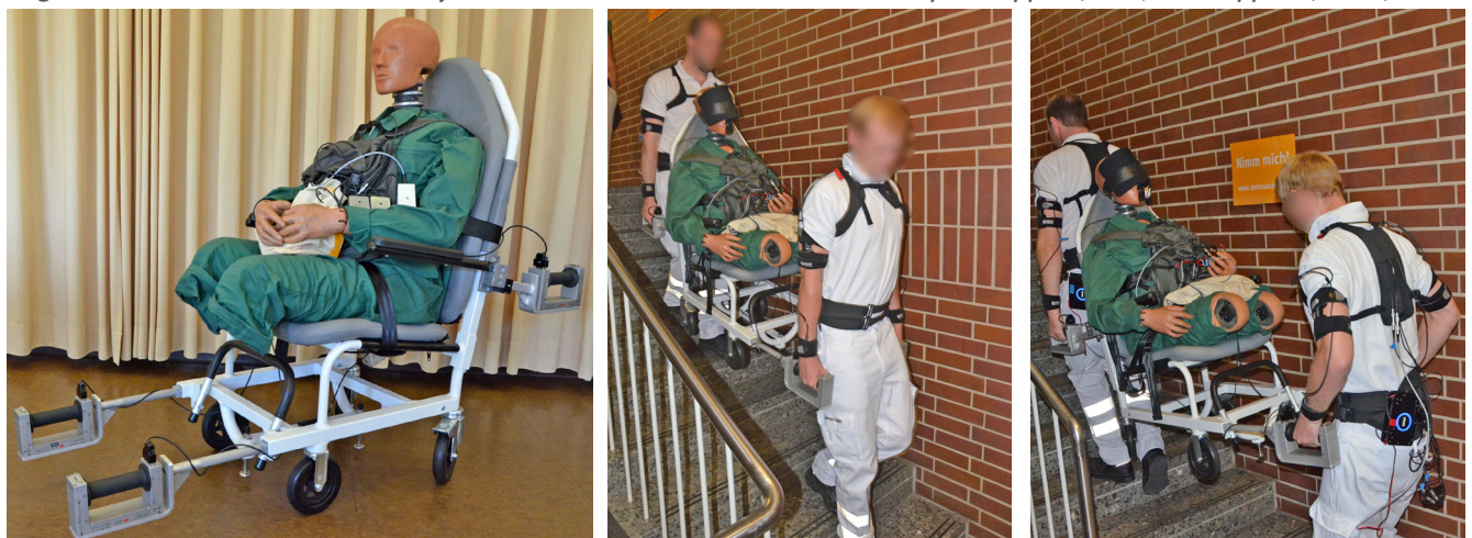
Abbildung 2.7: Tragestuhl mit Messtechnik und Dummy ohne Unterschenkel im Einsatz beim Transport treppab (Mitte) und treppauf (rechts)
