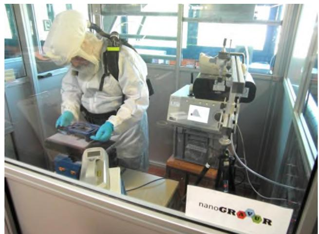
Testkammer für die Nachstellung von Tätigkeiten mit nanopartikelhaltigen Kompositen (Bild: IFA).
