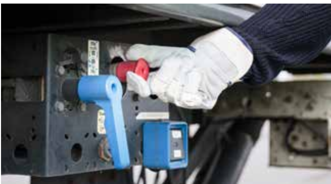
Abb. 65 Betätigen der Feststellbremse am Sattelanhängern
