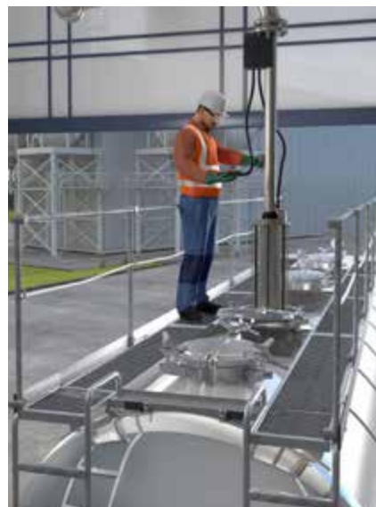
Abb. 23 Fahrzeug mit beidseitigem Laufsteg
