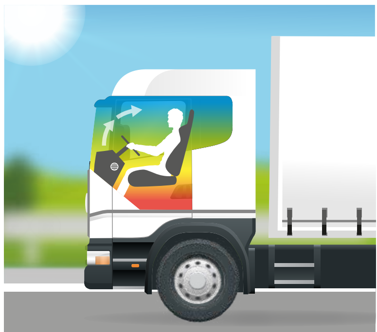
Abb. 37 Luftführung und Temperaturverteilung im Kühlbetrieb
