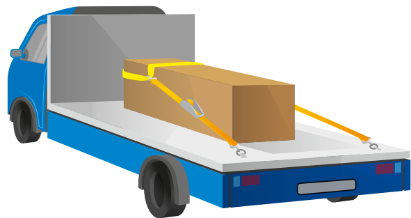
Abb. 74 Prinzipdarstellung: Zurren mit Kopfschlinge (Hebeband), zusätzliche Ladungssicherung zur Seite und nach hinten notwendig
