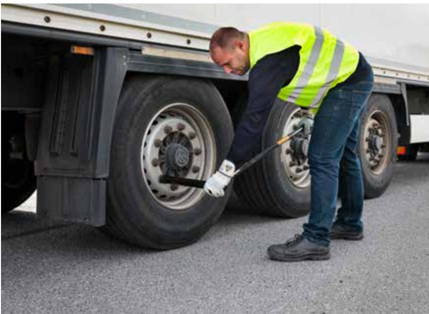
Abb. 66 Bei einem Radwechsel unterwegs Warnkleidung, Sicherheitsschuhe und Arbeitshandschuhe tragen
