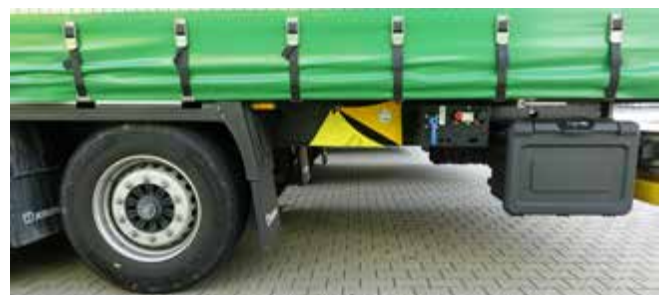
Abb. 7 Unterbringung der Unterlegkeile in der Nähe der Hinterachse
