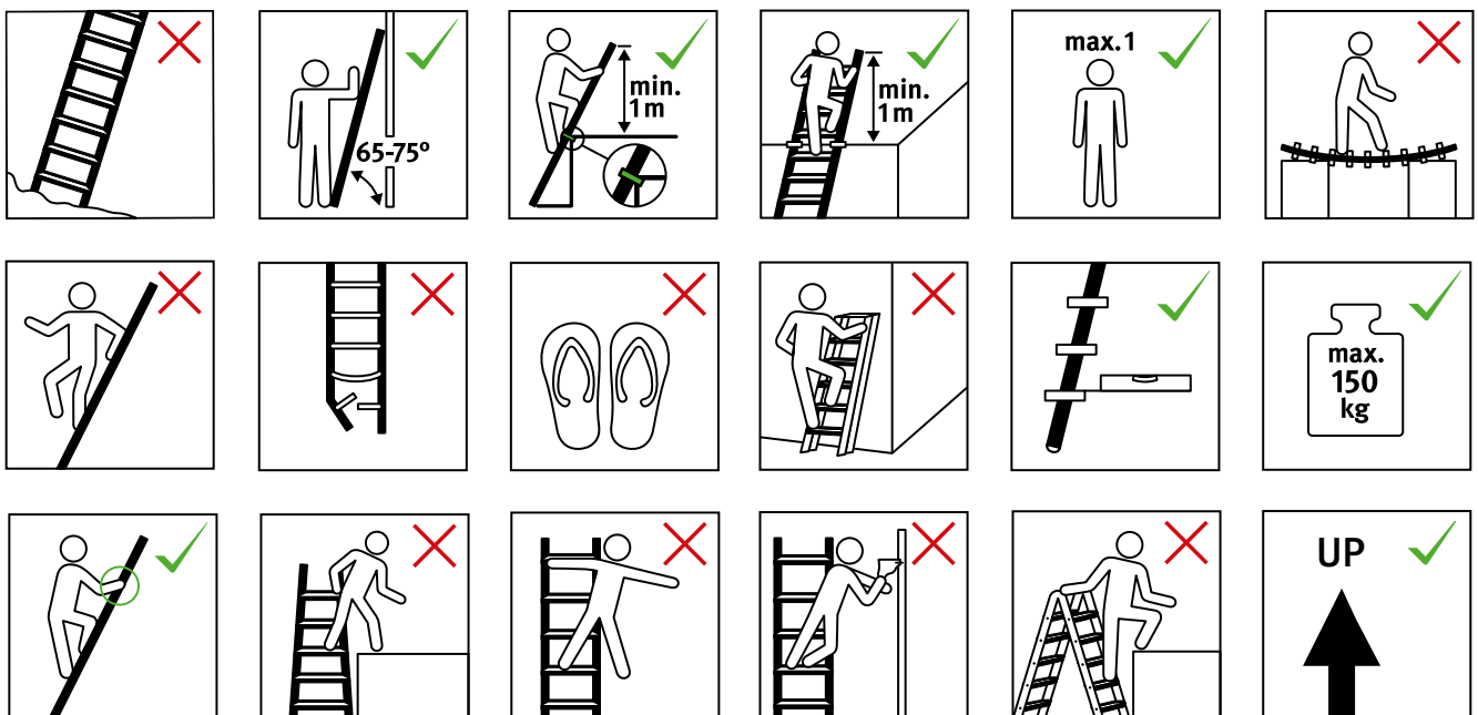
Abb. 53 Benutzungsanleitung von Leitern beachten
