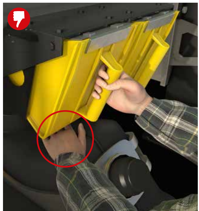
Abb. 5 Quetschgefahr bei der Entnahme von Unterlegkeilen
