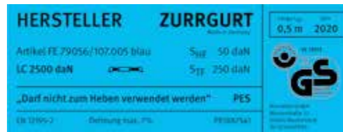
Abb. 10 Beispiel eines vollständigen Etiketts am Zurrgurt
