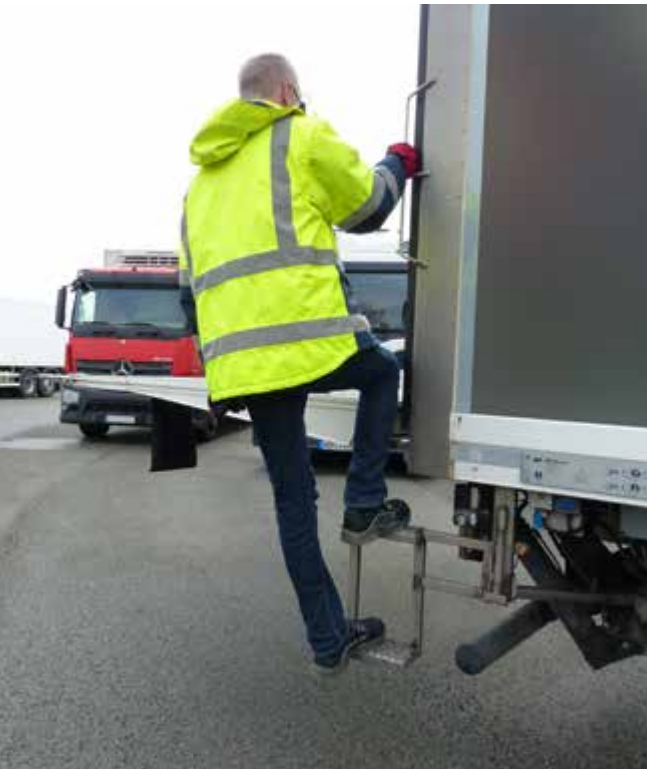
Abb. 29 Schwenkbarer Aufstieg zur Hubladebühne
