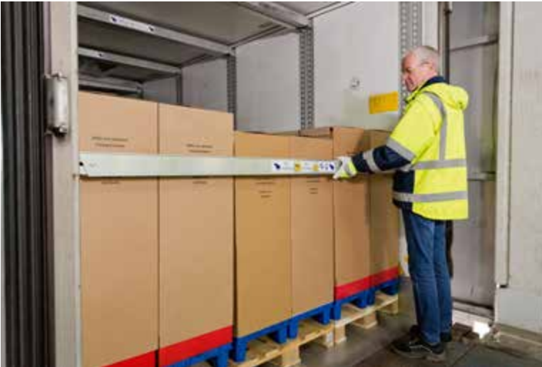
Abb. 11 Sperrbalken in Ankerschienen zum formschlüssigen Sichern von Ladung
