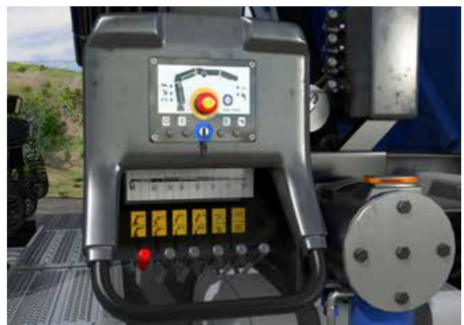
Abb. 28 Steuereinrichtungen mit Wahlschalter und NOT-HALT an Lkw-Ladekran
