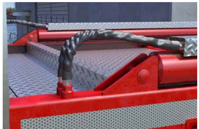
Abb. 30 Schutzüberzüge an Hydraulikleitungen in der Nähe eines Steuerstandes
