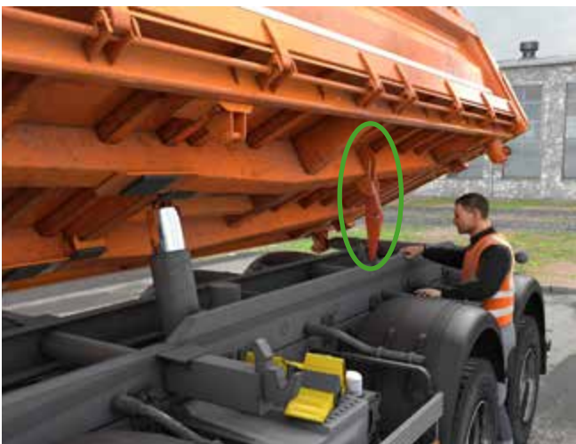
Abb. 21 Sicherung einer Kipperbrücke gegen unbeabsichtigtes Absinken
