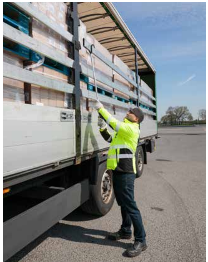
Abb. 69 Gabelstange zum Entnehmen von Steckbrettern
