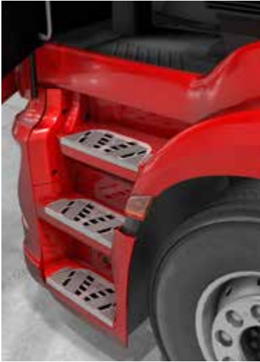
Abb. 14 Großflächige, trittsichere Auftritte
