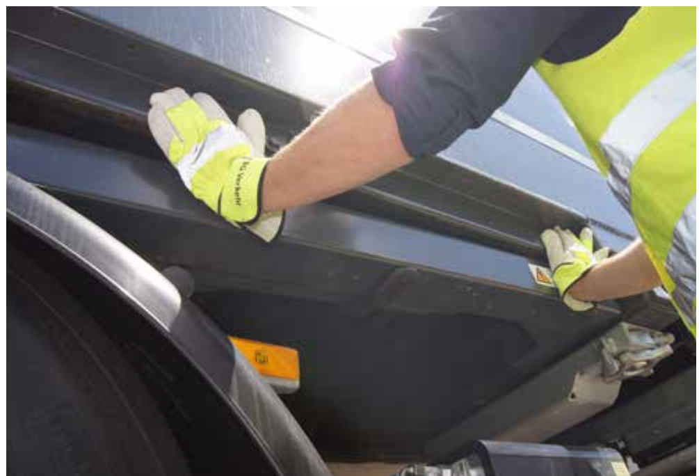
Abb. 81 Beim Einschieben der Stütze Quetschen der Hände vermeiden
