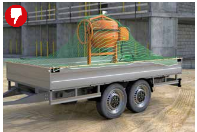
Abb. 13 Zur Ladungssicherung ungeeignetes Abdecknetz
