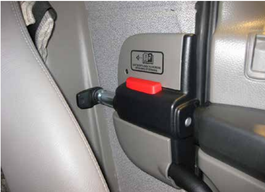
Abb. 19 Zusätzliche Sicherungen, die einen Einbruch in das Führerhaus erschweren
