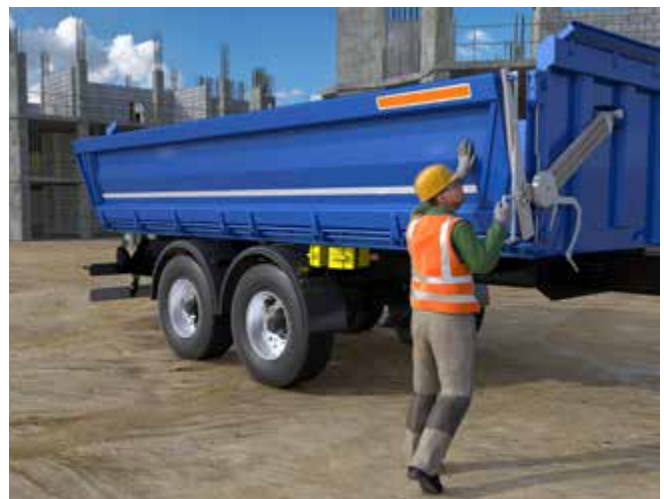
Abb. 22 Federentlastung für die seitliche Bordwand
