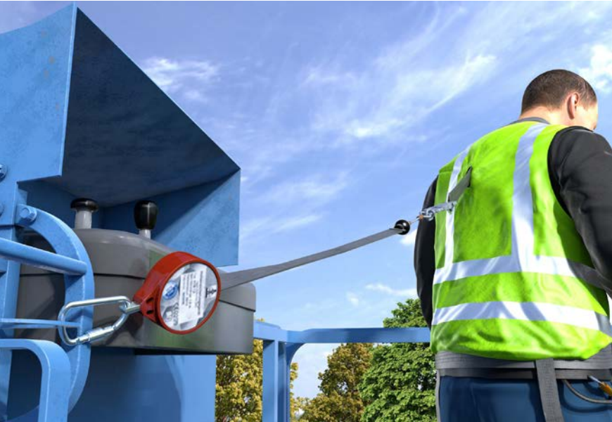
Abb. 90 Einsatz eines Höhensicherungsgeräts in der Arbeitsbühne
