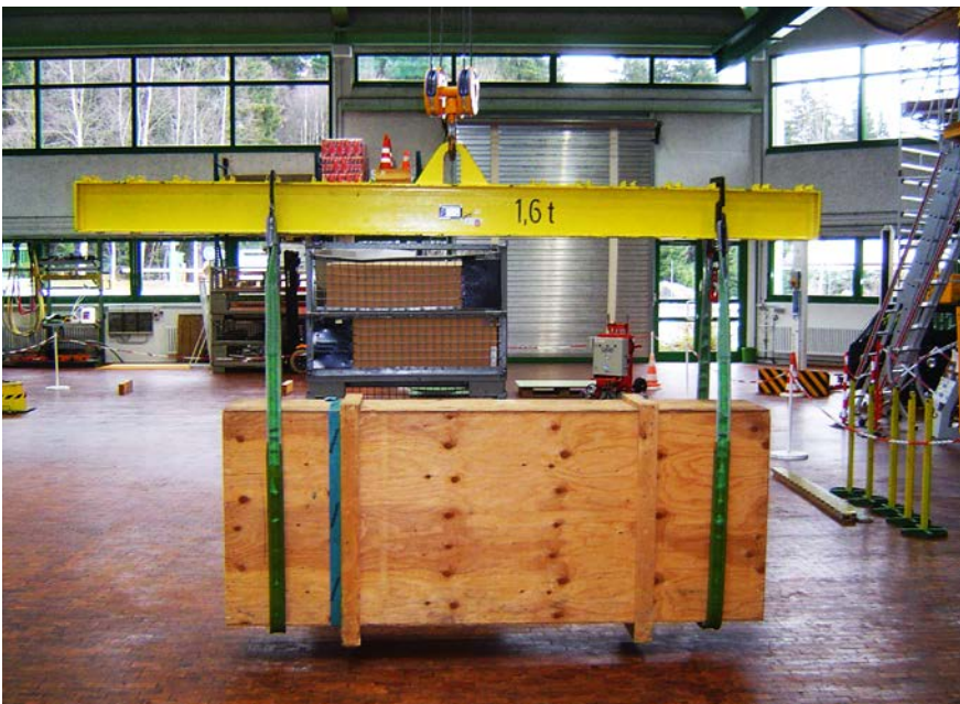
Abb. 105 Traverse mit angeschlagener Last
