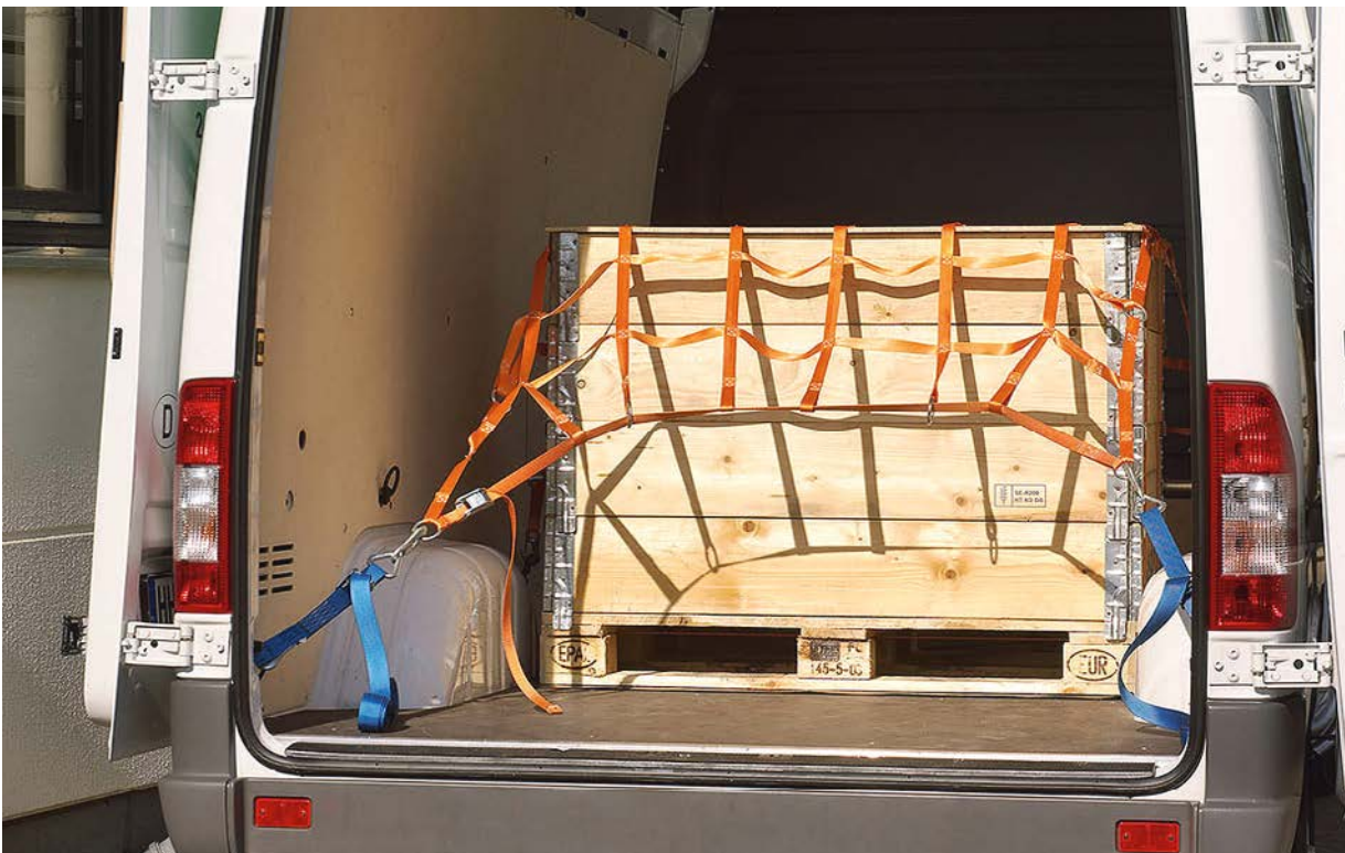
Abb. 101 Niederzurren eines freistehenden Ladeguts
