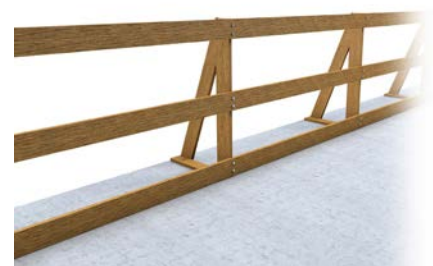
Abb. 80 Dreiteiliger Seitenschutz aus Holz
