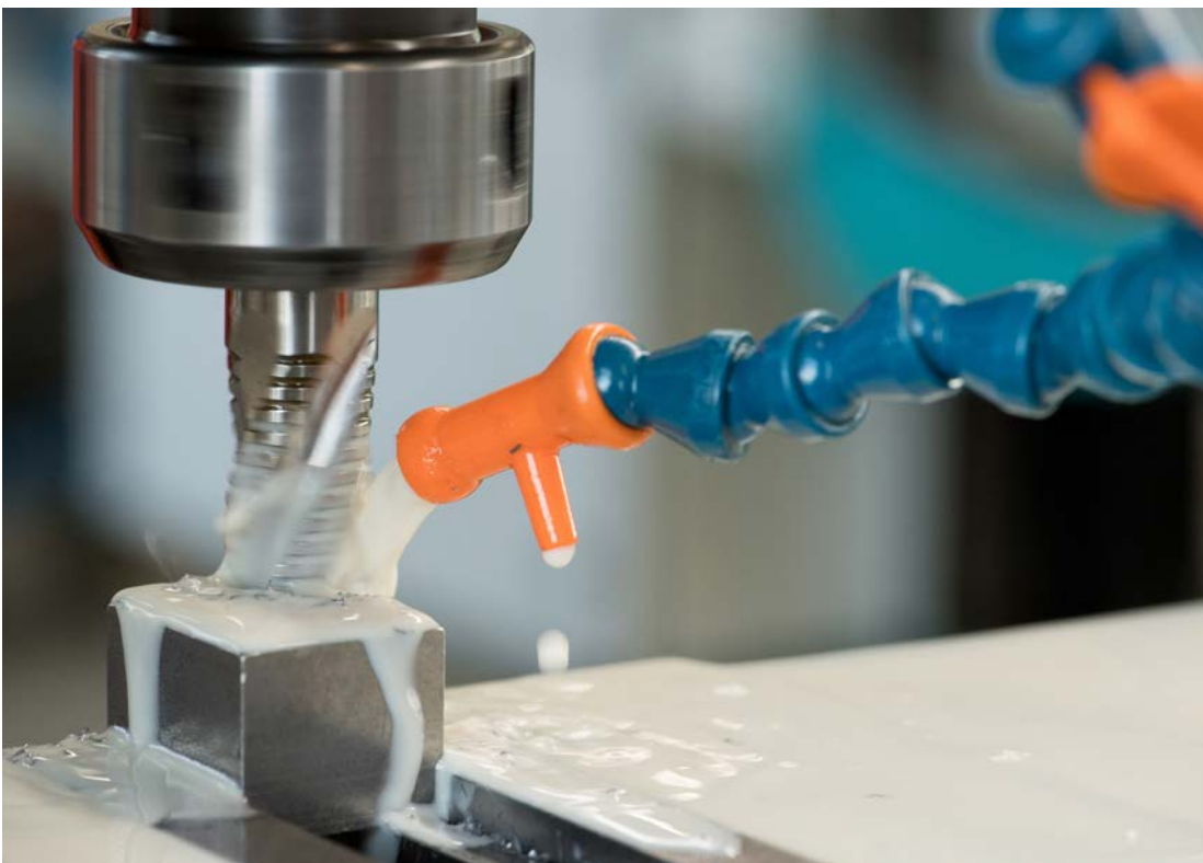
Abb. 3 Kühlschmierstoff in der Metallverarbeitung zur Wärmeabfuhr zwischen Werkstück und Werkzeug
