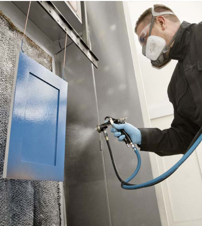
Abb. 72 Schutzkleidung beim Lackierspritzen
