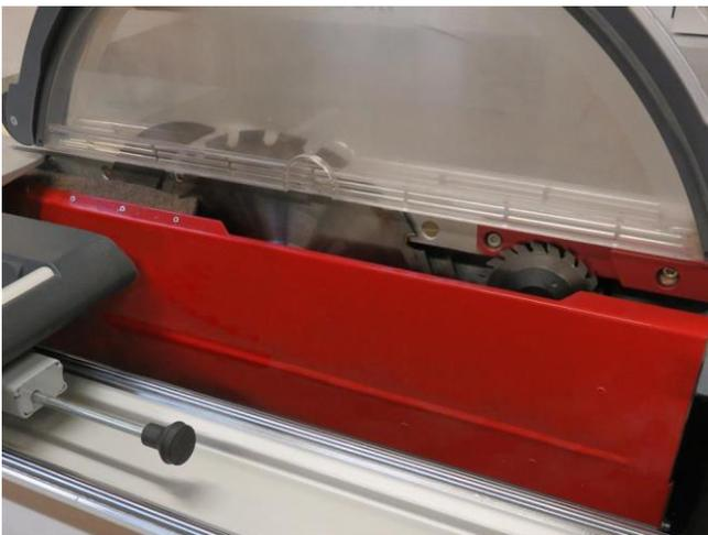
Bild 15: Sägeblattzugang unter dem Tisch
