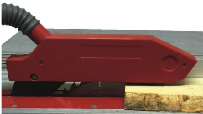
**Bild 9:** Schutzhaube am Spaltkeil befestigt
