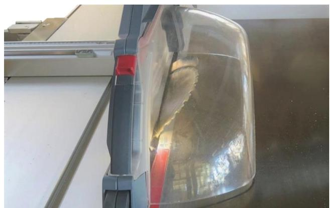
**Bild 11:** Breite Schutzhaube bei schräggestelltem Sägeblatt
