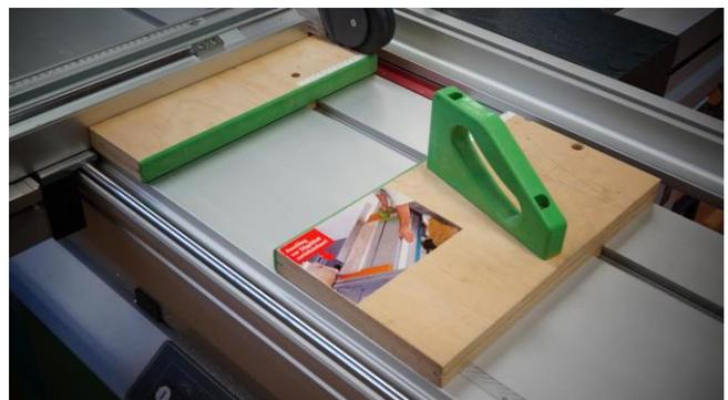
**Bild 19:** Beispiel für eine Sägehilfe
