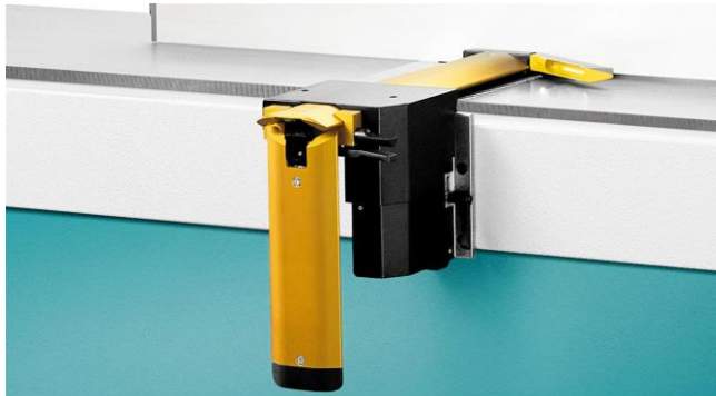
Bild 12: Selbsttätig einstellbarer Brückenschutz
