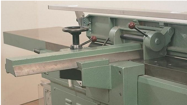
Bild 15: Anschlagführung ist gleichzeitig Messerwellenverdeckung
