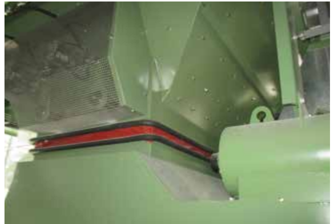
Abb. 46 Kompensationsmaterial am Übergang Waage/ Mischer
