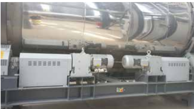
Abb. 35 Schutzeinrichtung an Laufrollen und Antriebswellen der Trockentrommel
