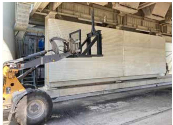
Abb. 54 Dorn zum Stochern als Anbauvorrichtung für Radlader mit Gabelausrüstung
