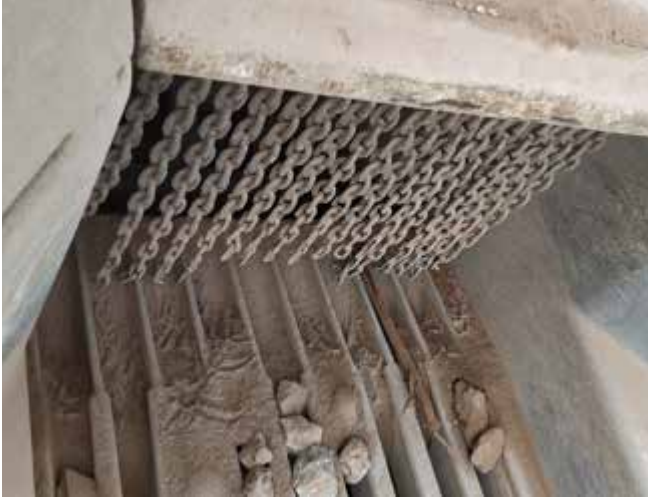
Abb. 56 Kettenvorhang gegen Herausschleudern von Material
