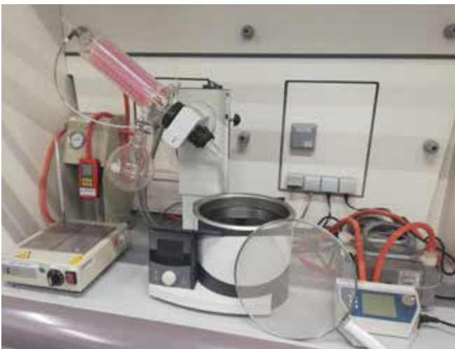
Abb. 86 Bitumenrückgewinnung durch Destillation des Extraktionsmittels am Rotationsverdampfer
