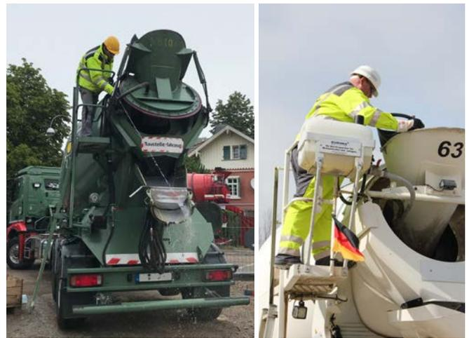
Abb. 21 Reinigen des Einlauftrichters und der Auslaufschurre
