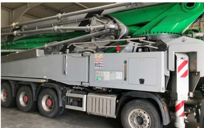
Abb. 30 Seitenkamera an der Betonpumpe
