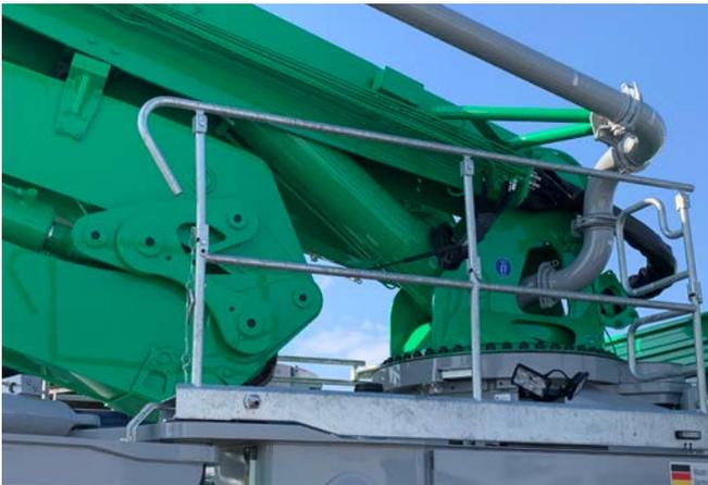
Abb. 24 Arbeitspodest und Absturzsicherung an der Betonpumpe
