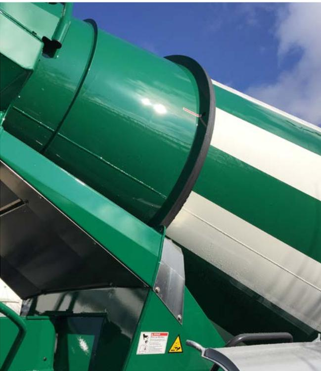
Abb. 7 Abgedecktes Trommellaufrad
