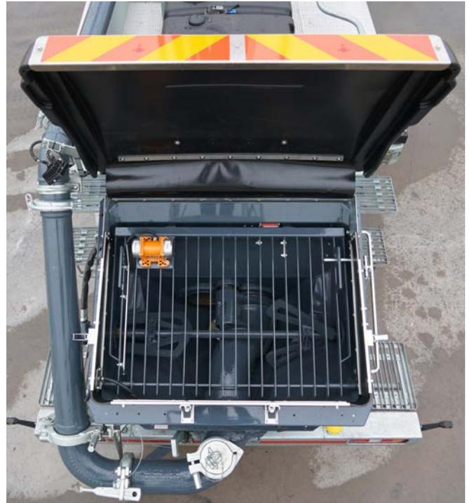
Abb. 38 Schutzeinrichtung, elektrisch verriegeltes Gitter, über dem Einfülltrichter der Betonpumpe
