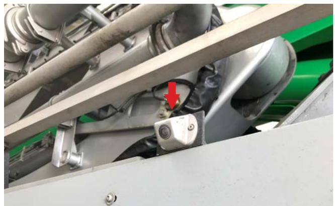
Abb. 31 Seitenkamera an der Betonpumpe
