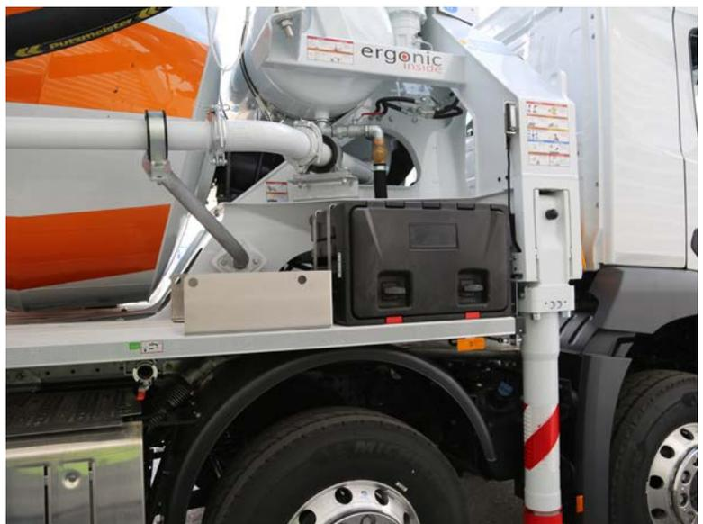
Abb. 12 Zubehörkasten am Fahrmischer für Kleinteile
