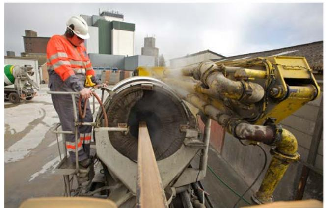
Abb. 42 Hochdruckwasserstrahlensysteme zur Fahr-Mischertrommelreinigung
