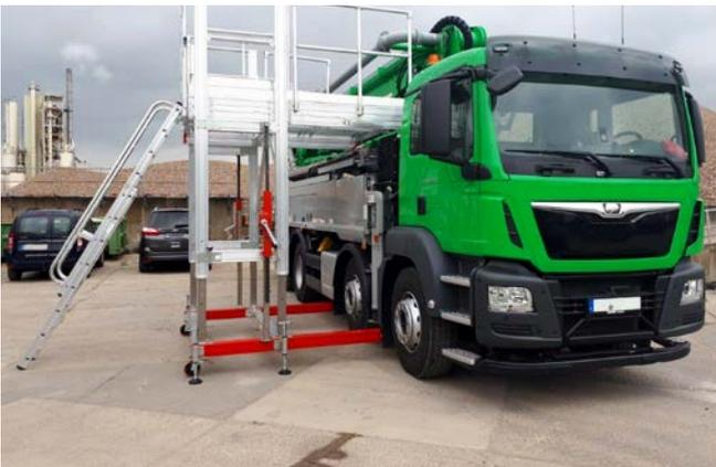
Abb. 41 Arbeitsbühne für die Instandsetzung einer Betonpumpe
