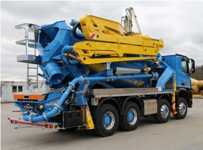
Abb. 39 Fahrnischerbetonpumpe
