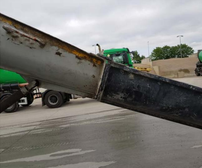
Abb. 16 Quetsch- und Scherstelle beim Einhängen der Verlängerung der Auslaufschurre
