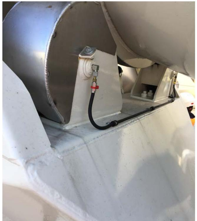
Abb. 8 Zentralschmierung Anschluss Tragrolle
