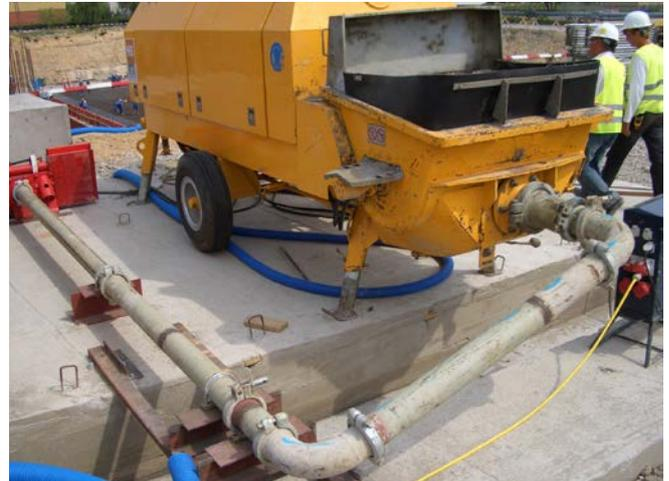
Abb. 40 Stationäre Pumpe mit Sperrschieber
