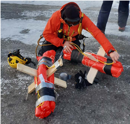
Abb. 46 Herstellen einer Wurfladung
