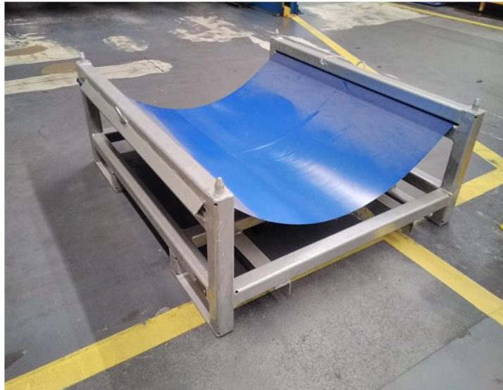
Bild 3: Rollenentnahmeeinrichtung (hier Transport mit Hubwagen)
