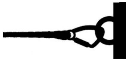
**Bild 5:** Befestigung des Lifeline-Systems an einer Anschlagvorrichtung
