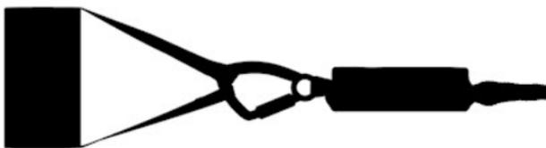
**Bild 3:** Bandschlinge als Befestigungsmöglichkeit für das Lifeline-System an der Konstruktion
