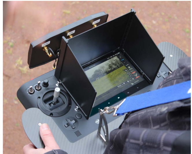
Abb. 14 Steuerung mit FPV-Bildschirm
