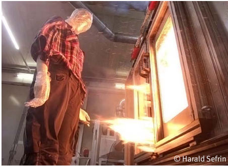
„Durchzündung“ an einer Werkzeugmaschine bei manipulierter offener Maschinentür ...
