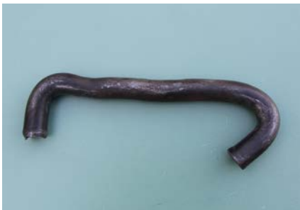
Gebrochenes Kettenglied einer Traversenkette.
