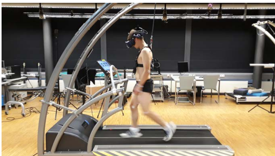
Untersuchungen zur Körper- und Gangstabilität während eines Trainings mit Stolpergefährdungen in einer virtuellen Umgebung. Quelle: Anika Weber.
