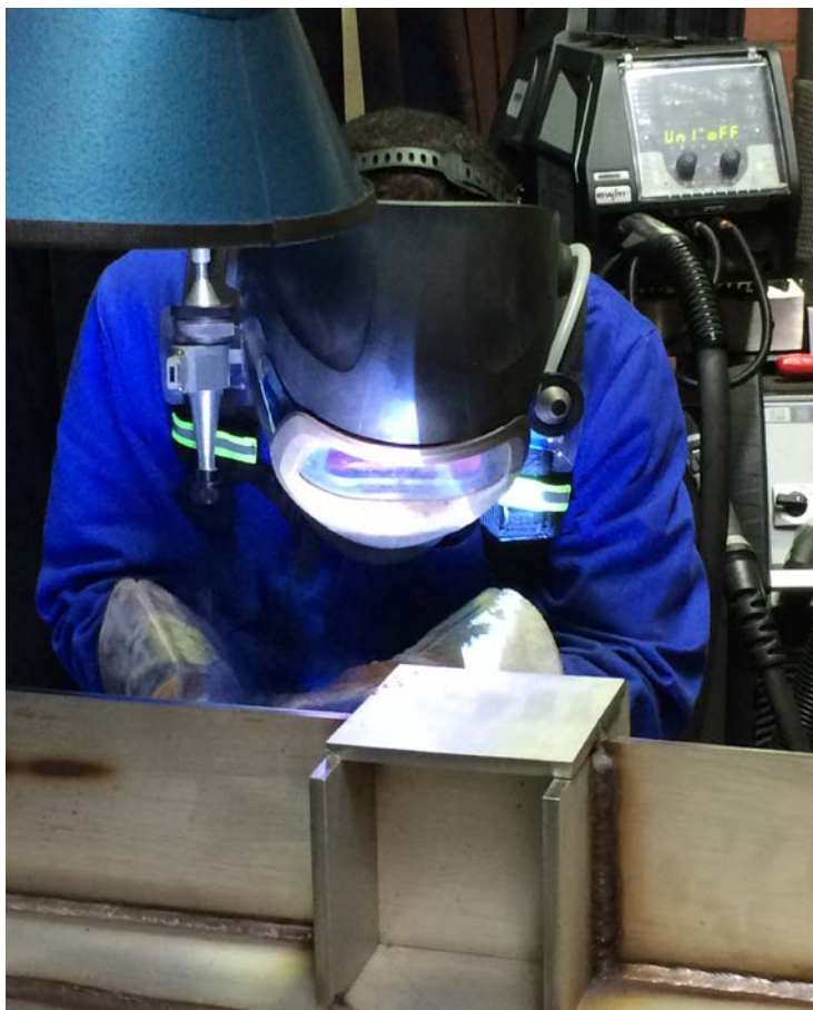
Schweißen einer Steignah an dem Musterbauteil aus 10 mm Chrom-Nickelstahlblechen.
