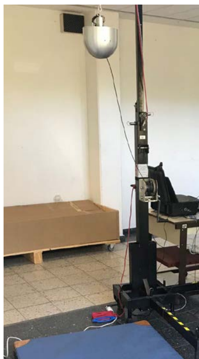
Versuchsaufbau zur Ermittlung der kritischen Fallhöhe.
