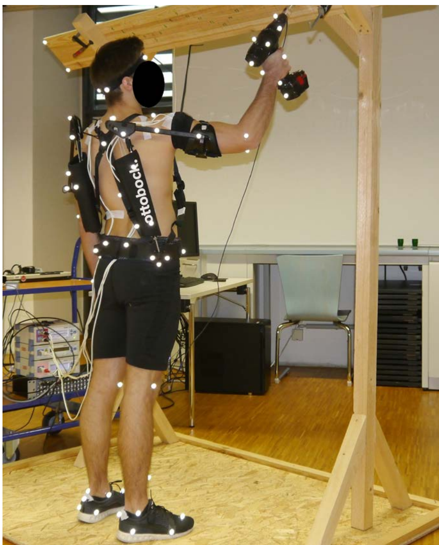
Messaufbau und Durchführung der Exoskelett-Laborstudie an einem Demonstrator.
