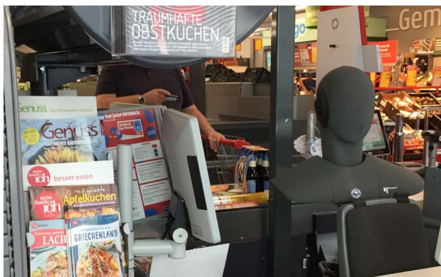
Mithilfe eines Kunstkopfes werden psychoakustische Kenngrößen ermittelt.
