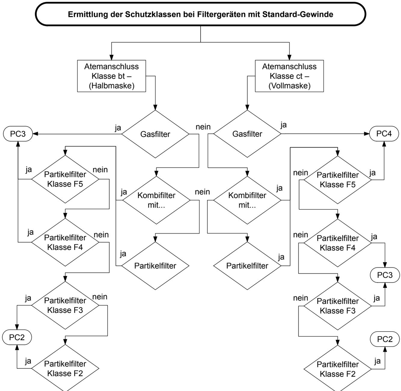
Abb. 9 Ermittlung der Schutzklassen bei Filtergeräten mit Standard-Gewinde
