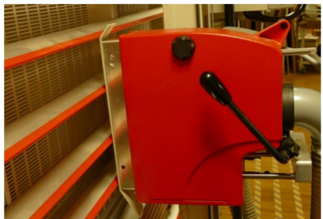
Bild 4: Beispiel Druckschuh und Bedienhebel
