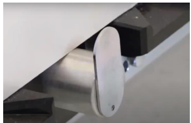
Bild 6: Beispiel: Rollenförmige untere Werkstückauflage
