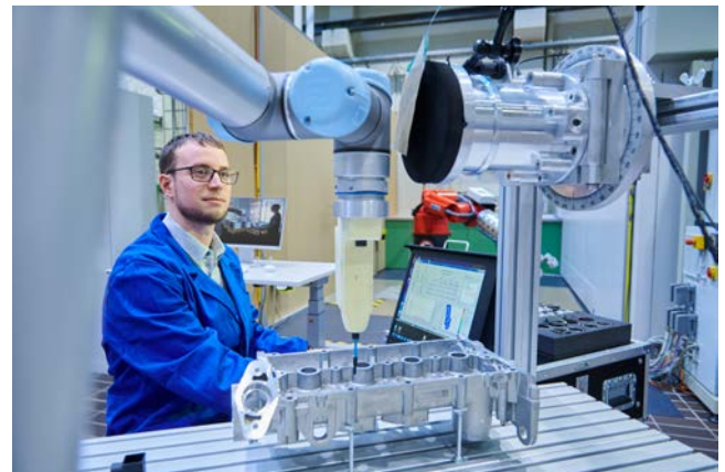
Prüfung der Kollisionskräfte eines kollaborierenden Robotersystems.
