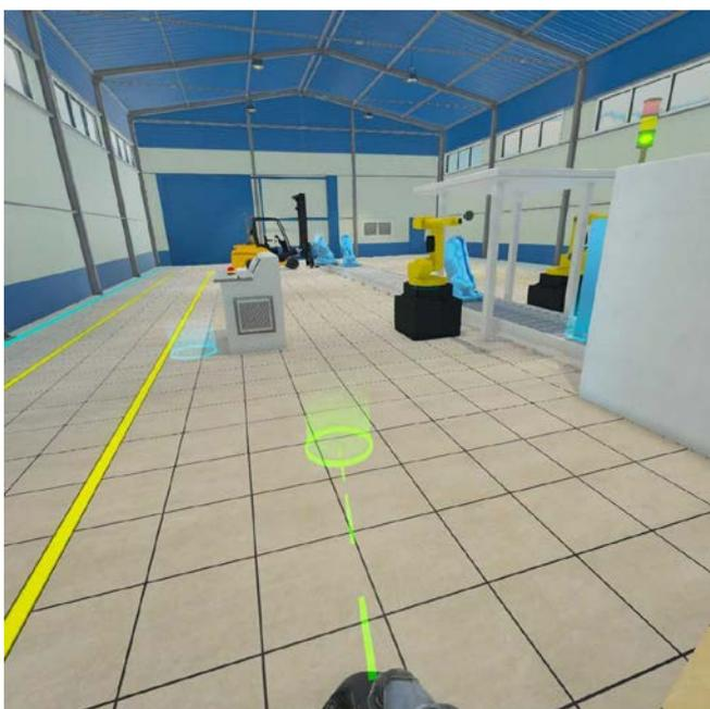
Abb. 2 VR-Modell mit Mensch-System-Interaktionen für Trainingsanforderungen: Begehen einer virtuellen Maschine
