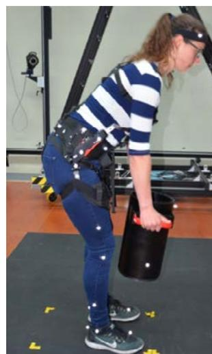
Abb. 2 Labormessung mit Motion Capturing System beim Anheben eines Lastgewichts mit Unterstützung eines Exoskeletts
