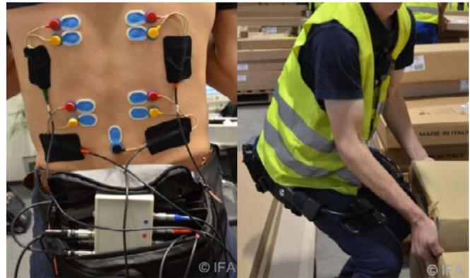
Abb. 4 Messsituation im betrieblichen Setting mit EMG-System (links) und während der Arbeit (rechts)
