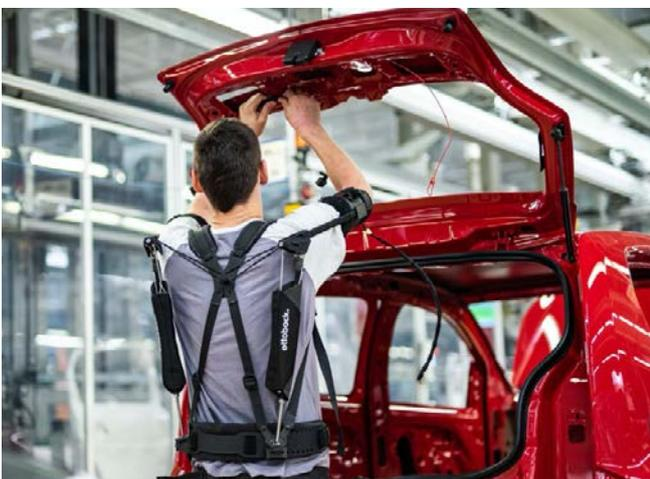
Abb. 1 Passives Exoskelett Paexo Shoulder von Otto Bock, Foto: © Volkswagen
