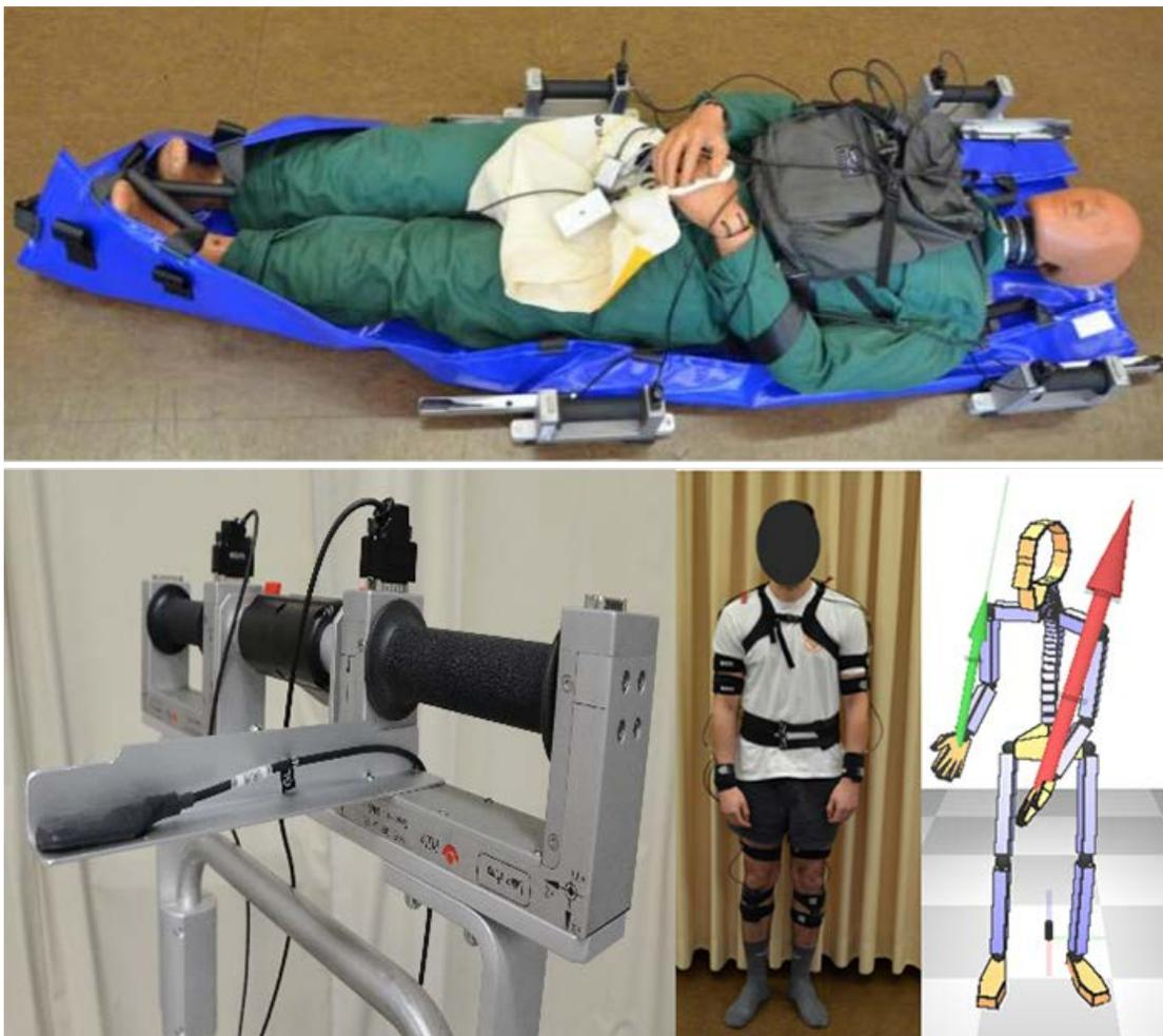
**Abb. 3** Inertielle Messeinheiten (IMU) am Körper bzw. in Kombination mit Kraftmessgriffen am Transportmittel
