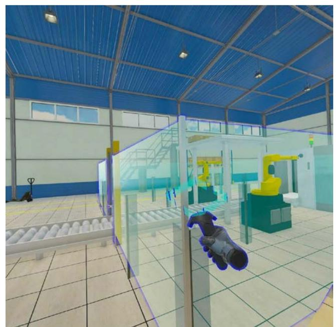
Abb. 3 Platzieren einer trennenden Schutteinrichtung im VR-Modell
