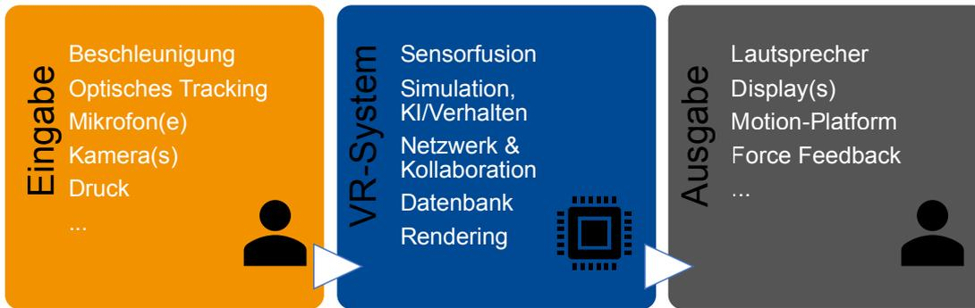
Abb. 2 Mögliche Zusammensetzung eines VR-Systems. Quelle: nach Dörner, et al.: Virtual und Augmented Reality (VR/AR) [4].
