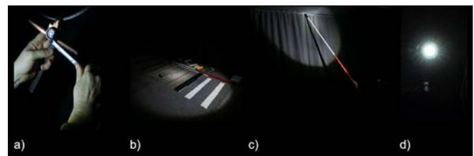
Abb. 3 a) Montagearbeiten im Greifraum, b) Gehen in der Gleisanlage, c) Orientierungsblick zum Einsatzort und Sicherheitseinrichtungen, d) Bewertung der Direktblendung beim Blick in einen Spiegel bei Tätigkeiten im Greifraum während der Laborstudie
