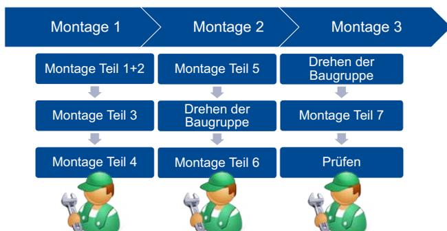
Abb. 2 Montage eines Produkts an verketteten Arbeitsplätzen
