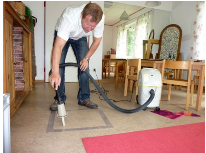
Abb. 2: Probenahme durch Absaugen des Fußbodens
