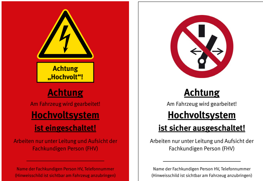
Abb. 7 Beispiele für die Kennzeichnung von HV-Fahrzeugen in der Werkstatt
