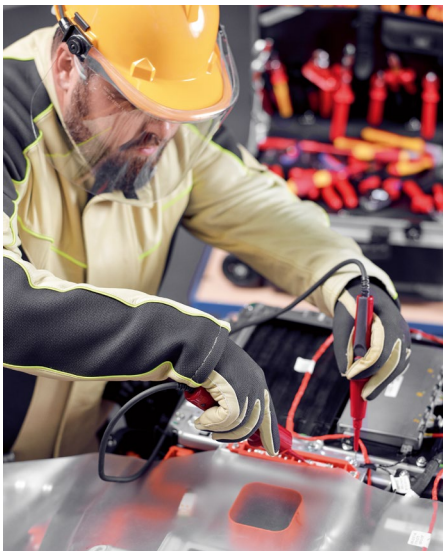
Abb. 10 Arbeiten an unter Spannung stehenden HV-Komponenten
