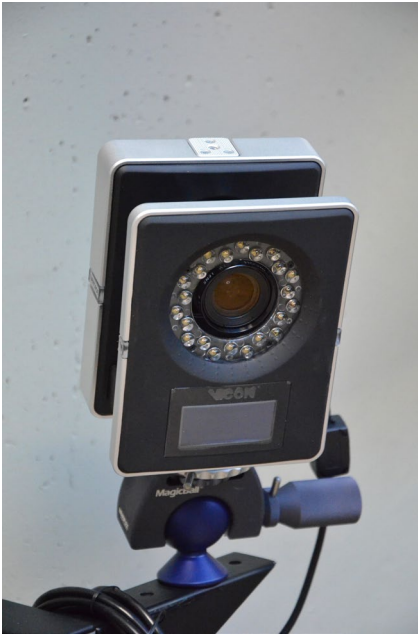
Abbildung 4: VICON®-Kamera mit kreisförmig um die Linse angeordneten Infrarot-LEDs
