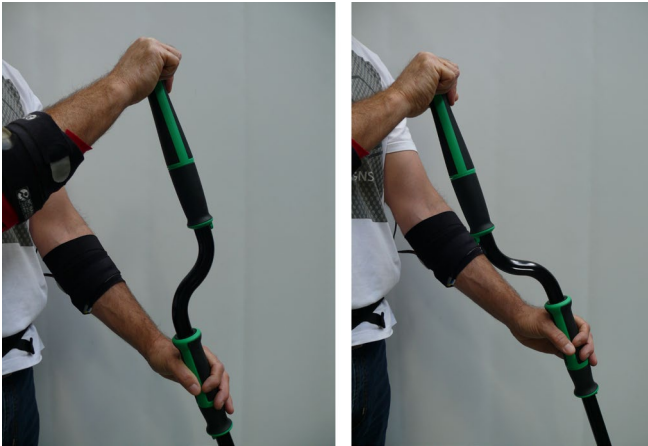
Abbildung 14: Greifvarianten mit dem grünen Stiel: obere Hand körperferner (links), obere Hand körpernäher (rechts) durch unterschiedliche Richtung der S-Form
