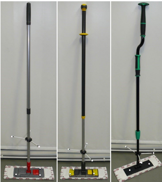
Abbildung 3: Reflektierende Marker an den Bodenwischerstielen
