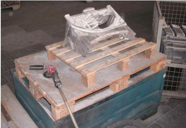
**Bild 2:** Ungeeigneter „improvisierter“ Schleifarbeitsplatz
