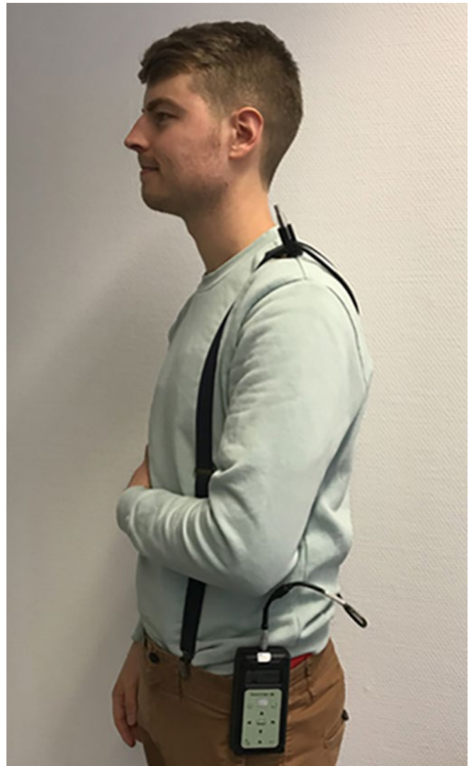
Abbildung 5: Das Mikrofon des Schallexposimeters wurde an einen Hosenträger fixiert, um die korrekte Messposition zu gewährleisten
