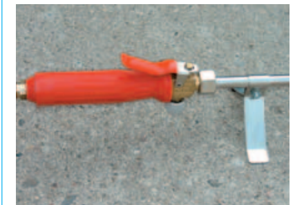
Bild 10-4: Brennergriffstück mit Flammenkleinstelleinrichtung
