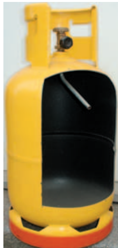
Bild 12-6: Aufgeschnittene Treibgasflasche mit gebogenem Tauchrohr zur Entnahme aus der Flüssigphase
