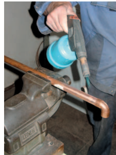
Bild 13-2: Lötbrenner mit Einwegkartusche
