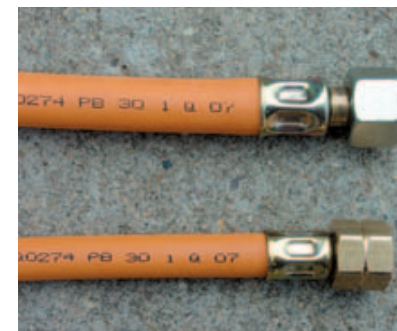
Bild 6-2: Hochdruckschläuche mit fest eingebundenem Anschluss mit Aufdruck der Druckklasse 30
