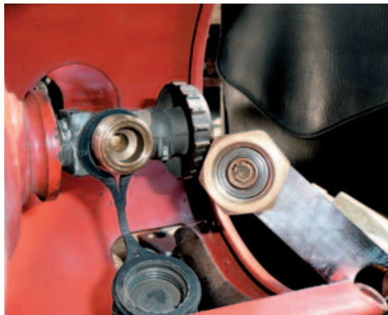
Bild 12-11: Anschluss einer Treibgasflasche mit Dichtung im Wechselflaschenanschluss
