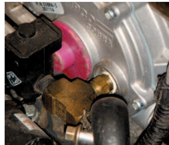
Bild 12-10: Verbesserter Verdampfer-Druckregler mit Abdeckung auf Choke-Knopf
