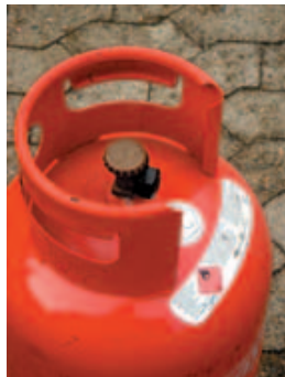
Bild 12-5: 11-kg-Treibgasflasche mit Schutzkragen für Treibgas-Stapler
