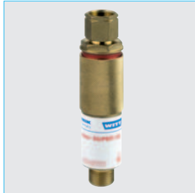
Bild 8-6: Beispiel einer Sicherheitseinrichtung nach DIN EN 730-1 gegen Gasrücktritt und Flammendurchschlag mit druckgesteuerter Nachströmsperre und Sichtanzeige (Quelle: Witt-Gasetechnik)
