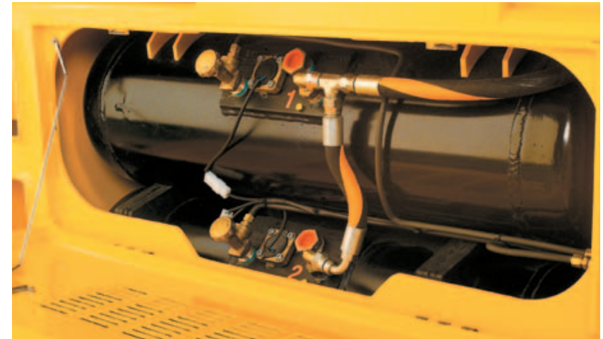
Bild 12-7: Im Fahrzeug fest eingebaute Tankbehälter (TB) – (Quelle: Jungheinrich)
