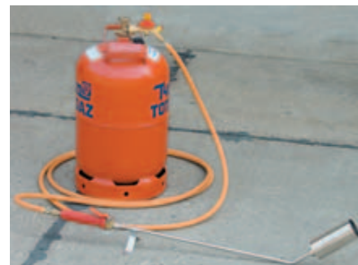
Bild 10-1: Bauhandbrenner mit Druckregler mit Schlauchbruchsicherung und integrierter Dichtheitsprüfung
