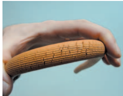
Bild 6-3: Gealterter brüchiger Schlauch
