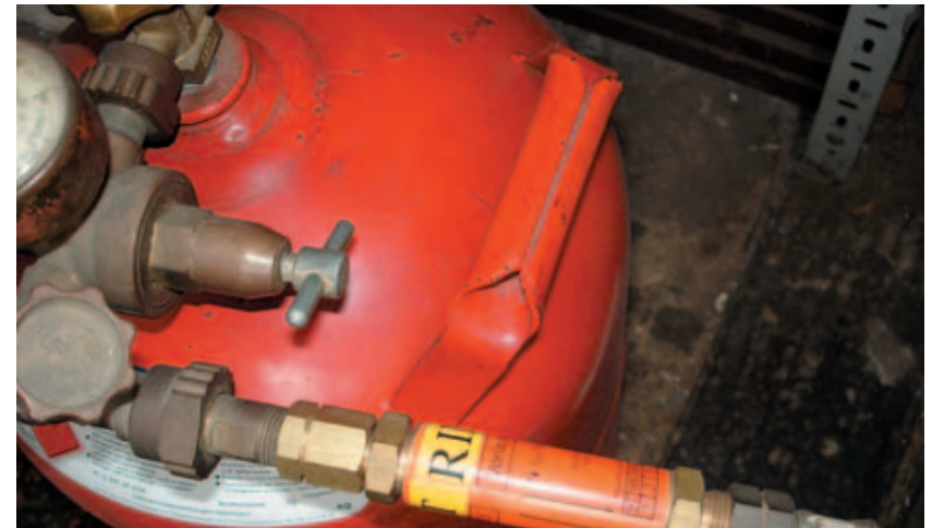
Bild 8-5: Sicherheitseinrichtung – zur Absicherung des Brenngasschlauches ist die Installation unmittelbar vor das Brennerhandstück notwendig
