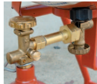
Bild 4-7: Verbindung der Flaschen mittels Umfüllstutzen
