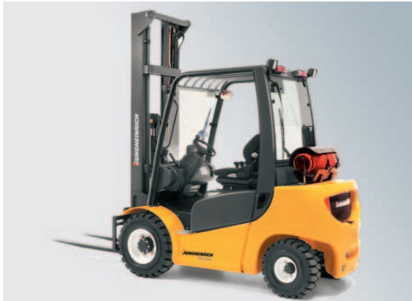
Bild 12-1: Treibgas-Stapler mit Versorgung aus Treibgasflasche (Quelle: Jungheinrich)
