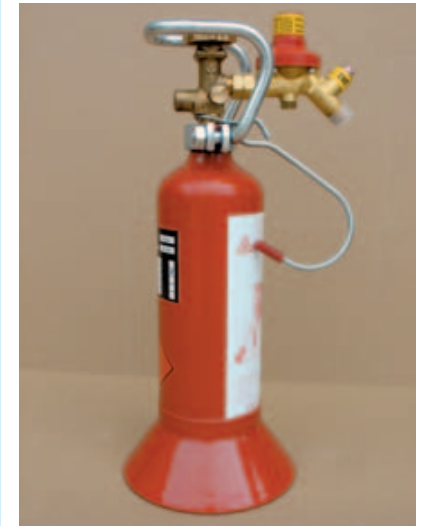
Bild 7-1: Kleinflasche mit Druckregler in abgewinkelter Bauart, wodurch ein Knicken des Schlauches vermieden wird (Flasche mit Armaturenschutzbügel für den Transport)
