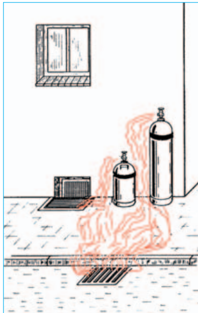
Bild 1-5: Gefahr des Einfließens von Flüssiggas in Kellerschächte und Kanäle
