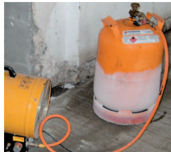
Bild 4-16: Vereisung an einer Kleinflasche bei hoher Entnahmelistung
