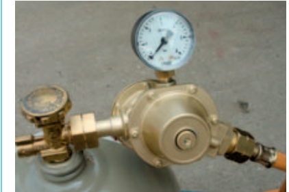
Bild 8-2: Beispiel einer Leckgassicherung (nur mit Spezialdoppelschlauch!)
