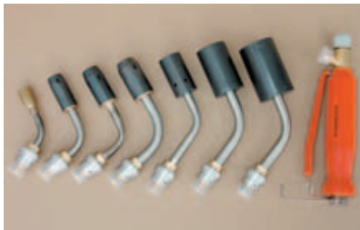
Bild 9-4: Löt- und Schrupfbrenner-einsätze und Handstück mit Flammenkleinstellung
