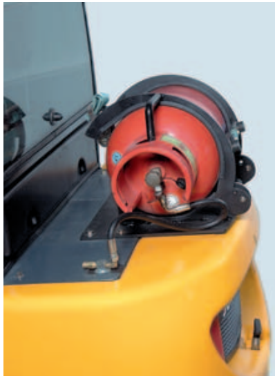
Bild 12-9: Sicher befestigte und angeschlossene Treibgasflasche (Quelle: Jungheinrich)
