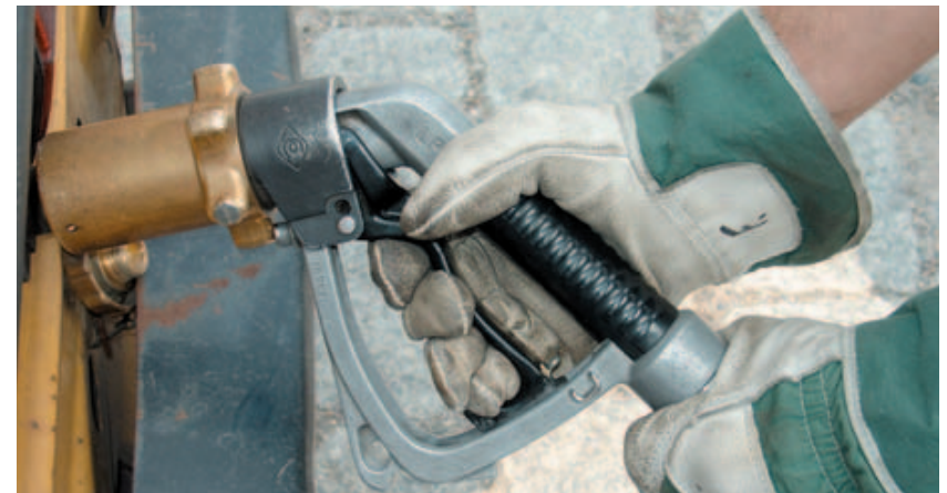
Bild 12-12: Betankung eines Treibgasfahrzeuges, geschützt mit Lederhandschuhen
