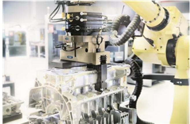
**Bild 8:** Formschlüssiger pneumatischer Greifer am Roboter
