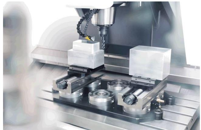
**Bild 4:** Pneumatisches Nullpunktspannsystem mit Werkstücken in mechanischen Schraubstöcken
