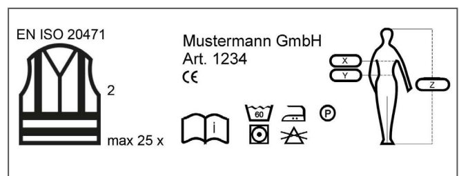
Abbildung 17: Kennzeichnung einer „Hochsichtbaren Warnkleidung“, die Zahl neben dem graphischen Symbol (2) gibt die Bekleidungsklasse nach Tabelle 1 (DIN EN ISO 20471) und „max. 25 x“ die maximale Zyklenzahl an Reinigungen an. Quelle: DGUV
