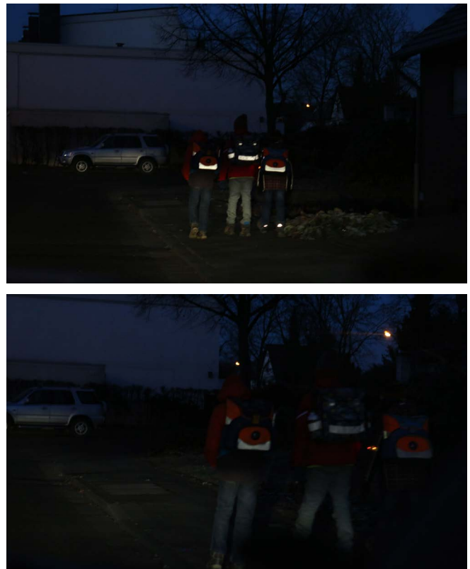
Abbildung B28 und B29: Wirkungsweise retroreflektierender Bestandteile auf Ranzen
