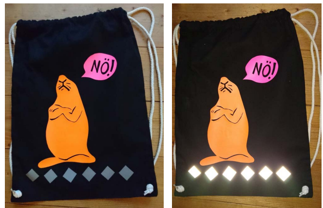
Abbildung 31: Wirkungsweise der Retroreflektion ohne und mit Fotoblitz. Quelle: DGUV
