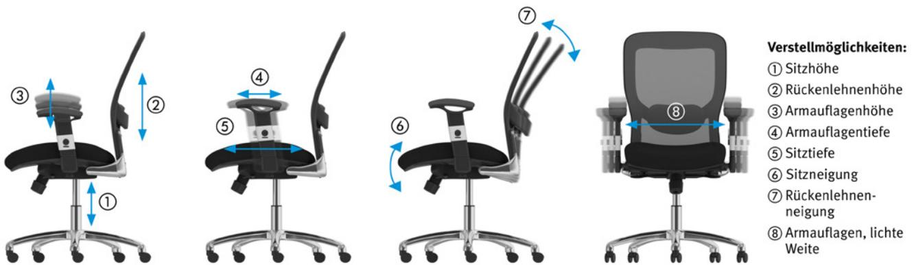
Abb. 34 Verstellmöglichkeiten an einem Büroarbeitsstuhl
