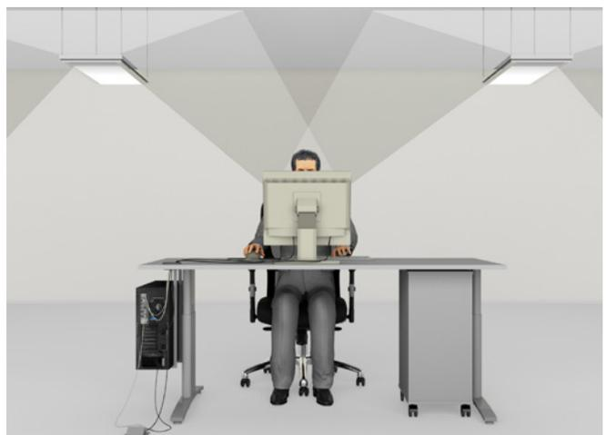
Abb. 45 Beispiel für Direkt-/Indirektbeleuchtung
