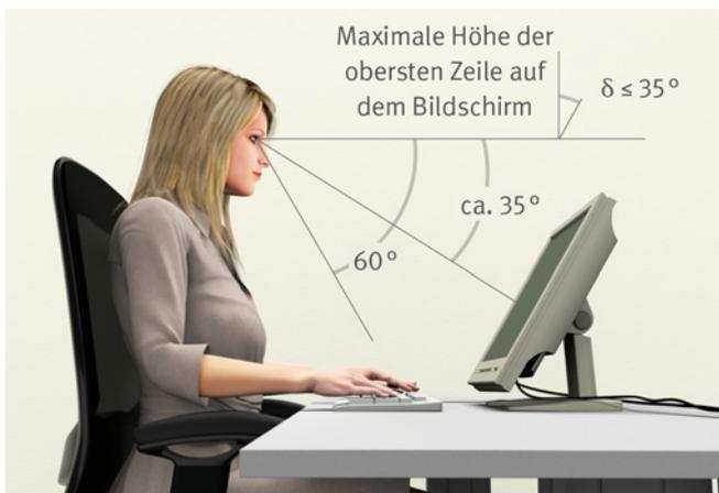
Abb. 20 Vertikales Blickfeld und Anordnung des Bildschirms
